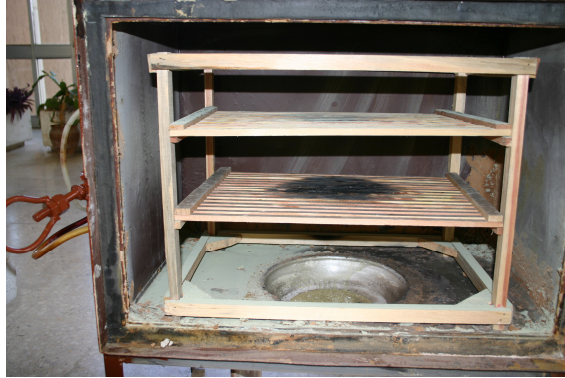
Şekil 3.2. Kayısı örnekleri için kükürtleme kabini
