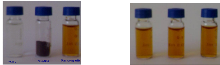
Şekil 3.17. a) PMAs, \text{NiFe}_2\text{O}_4 ve PMAs- \text{NiFe}_2\text{O}_4 görüntüleri b) 1 hafta, 1 ay ve 8 ay bekletildikten sonra kolloidlerin görünümü
