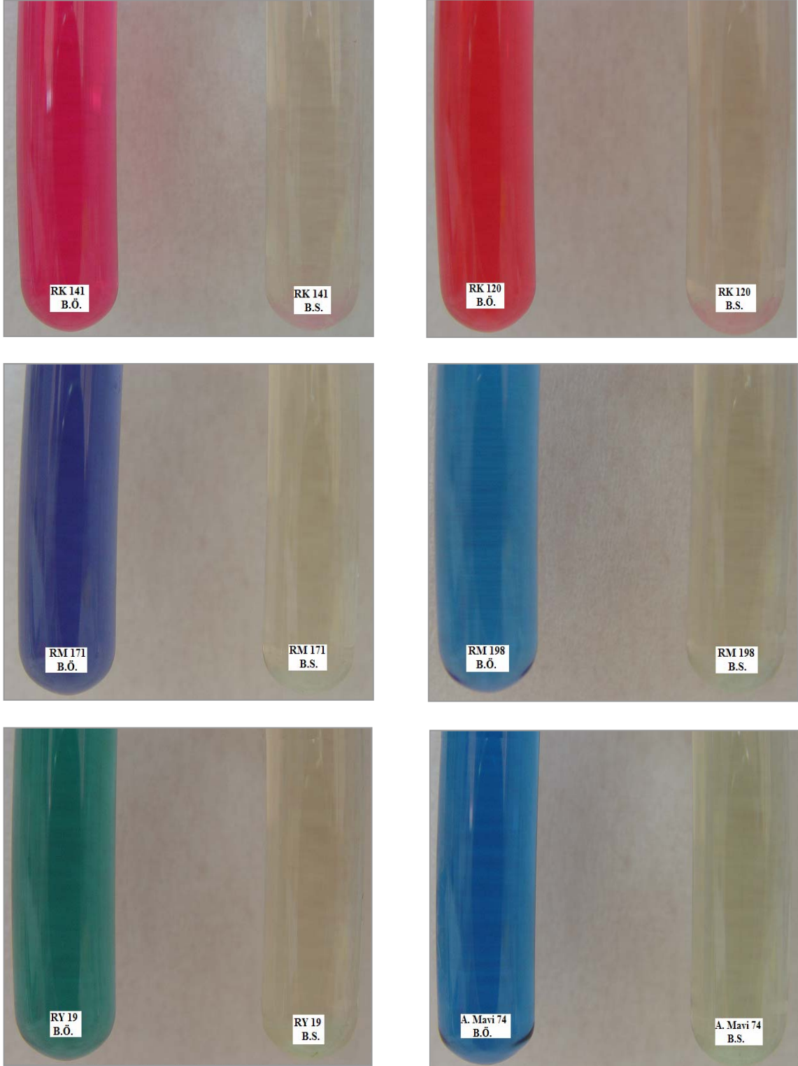
Şekil 4.41. Boyalı atık suların biyoteknolojik işlem öncesi (B.Ö.) ve sonrası (B.S.) görüntüleri. Fungus türü: P. chrysosporium (Görüntüler renk giderimi işleminin 24.saatinde alındı)
