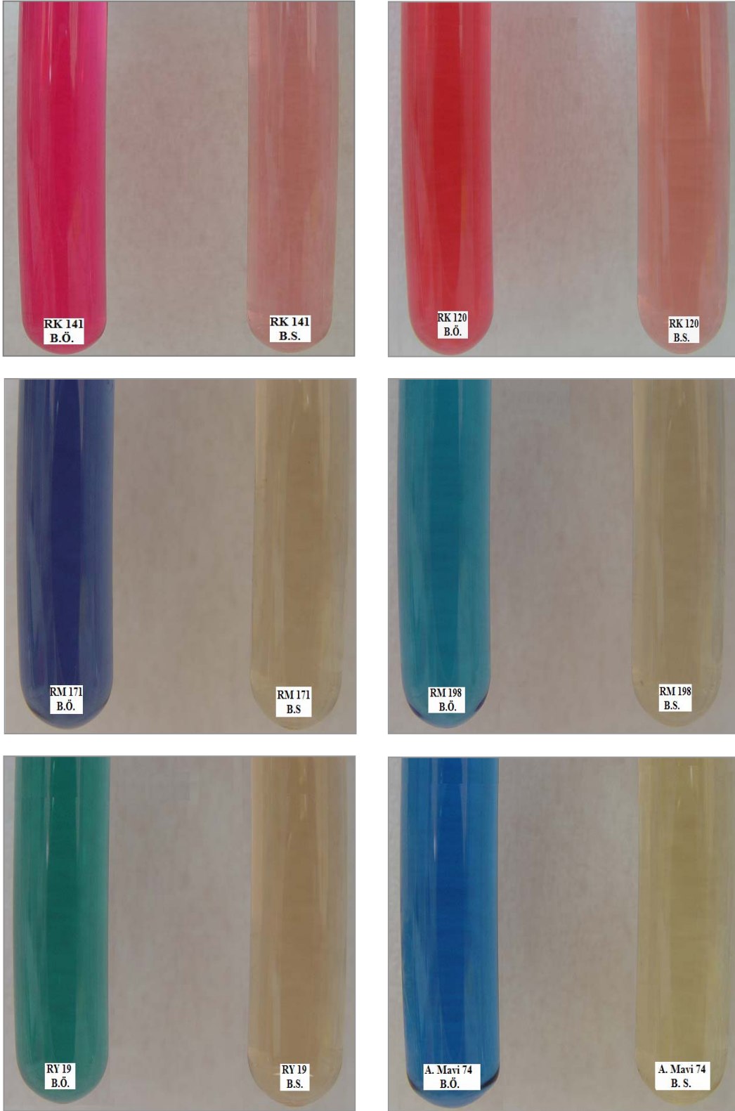
Şekil 4.33. Boyalı atık suların biyoteknolojik işlem öncesi (B.Ö.) ve sonrası (B.S.) görüntüleri. Fungus türü: T. versicolor (Görüntüler renk giderimi işleminin 24.saatinde alındı)
