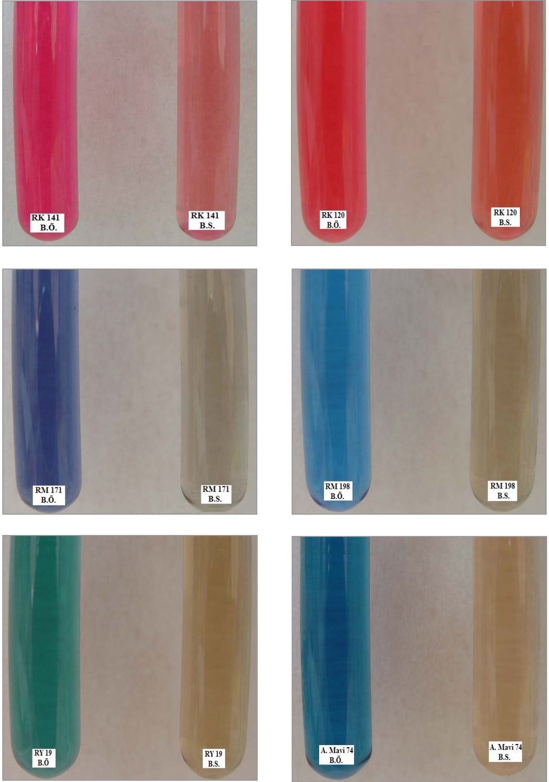
Şekil 4.37. Boyalı atık suların biyoteknolojik işlem öncesi (B.Ö.) ve sonrası (B.S.) görüntüleri. Fungus türü: F. trogii (Görüntüler renk giderimi işleminin 24.saatinde alındı)
