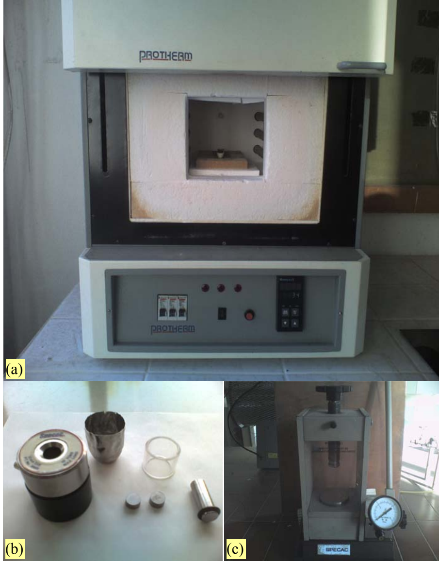
Şekil 4.4. Numune hazırlama ve ısıl işlemler için kullanılan kül fırını(a), peletleme sistemi(b) ve maksimum 15 ton kapasiteli presleme sistemi(c).
