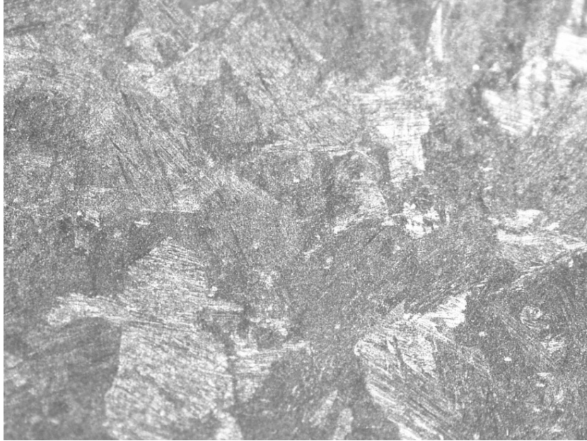
Şekil 4.14. 30 dk homojenleştirilen malzemenin optik mikroskopla \times 5000 büyütmeyle çekilmiş fotoğrafı
