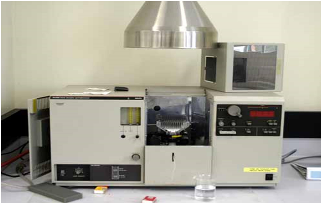
Şekil 3.1. \text{Cu}^{2+} iyonlarının ölçümünde kullanılan FAAS
