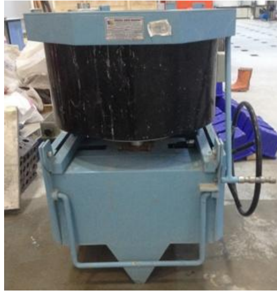
Şekil 3.9. Geopolimer beton karışımlarının hazırlandığı mikser
