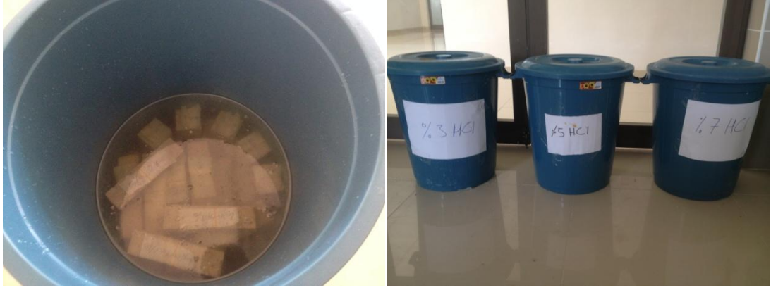
Şekil 3.27. HCl çözeltisine maruz bırakılmış geopolimer beton numuneleri
