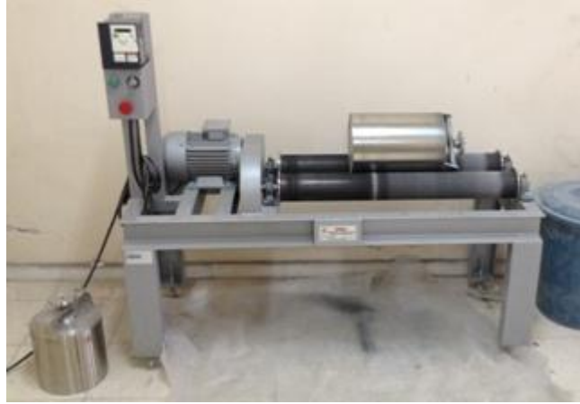
Şekil 3.17. Numune öğütmede kullanılan bilyeli değirmen
