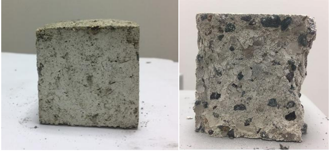
Şekil 3.24. Sertleşmiş haldeki geopolimer beton numuneleri
