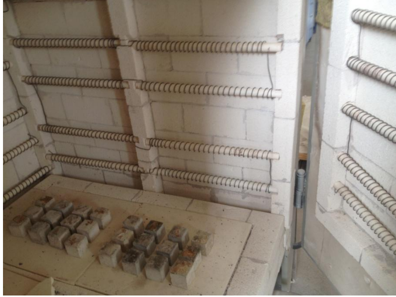
Şekil 3.26. Yüksek sıcaklık direnci için fırına yerleştirilmiş geopolimer beton numuneleri
