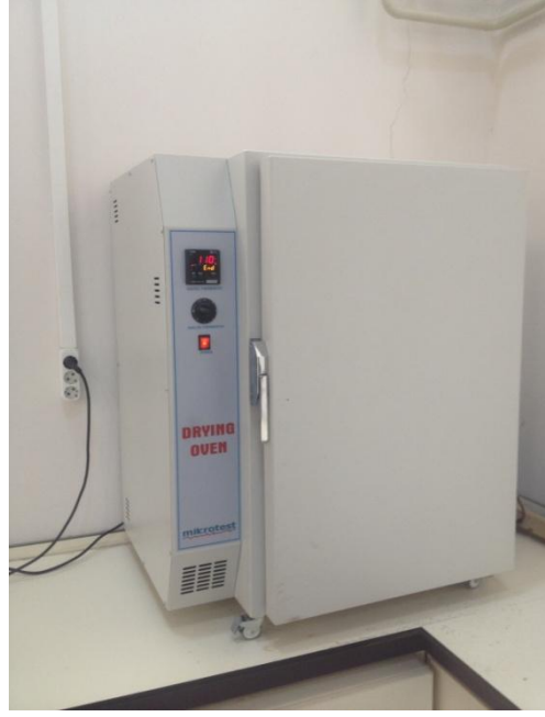
Şekil 3.14. Geopolimer numunelerin kür edildiği etüv
