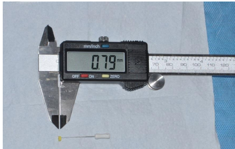
Şekil 3.3. Dişeti kalınlığının dijital kumpas ile değerlendirilmesi
