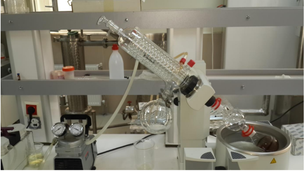
Şekil 3.1. Ekstredeki çözügen (metanol) rotavaporda uçurularak uzaklaştırılması.
