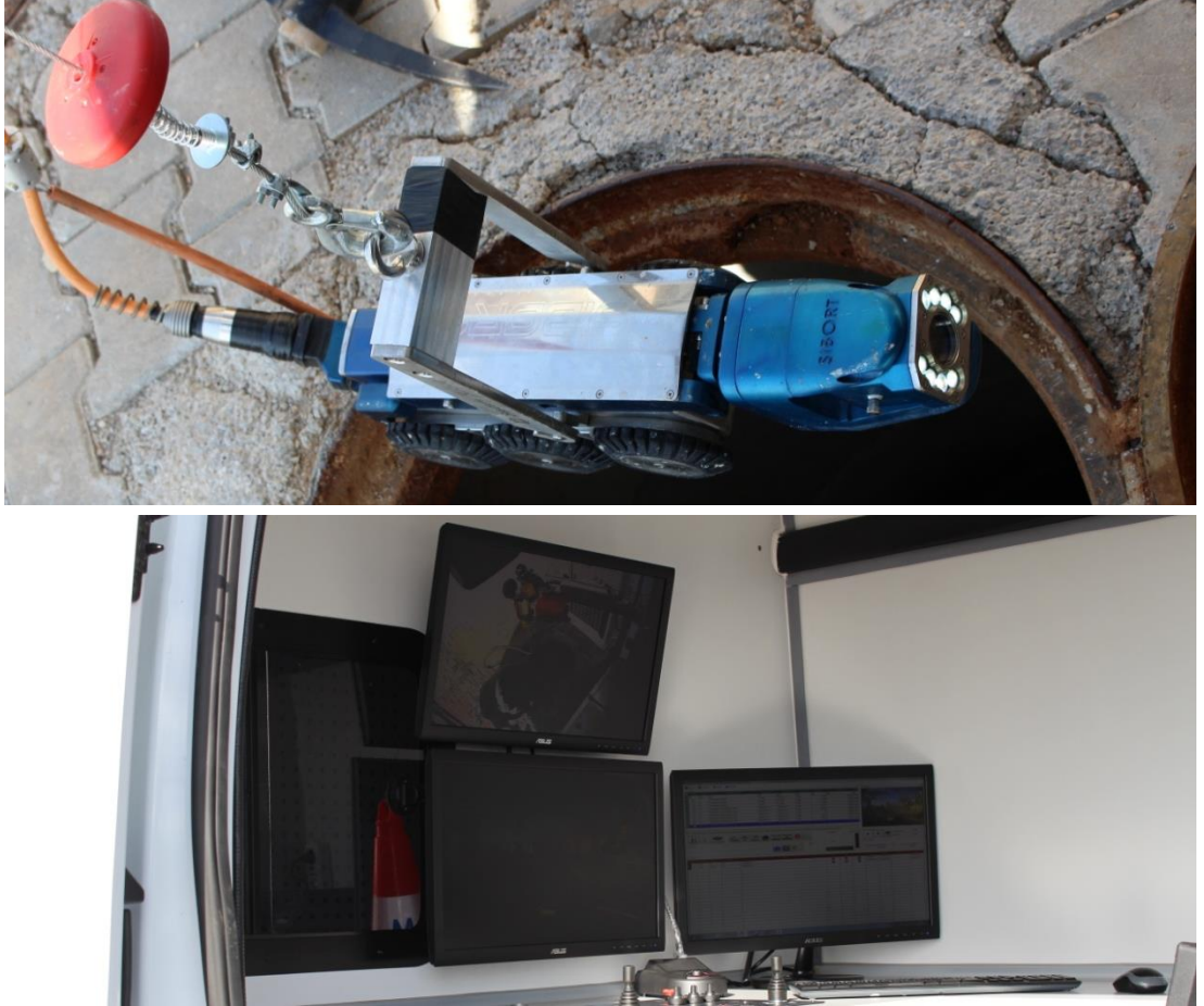
Şekil 4.4. Kanal Görüntüleme Aracı ve Kapalı Devre TV (MASKİ, 2018)
