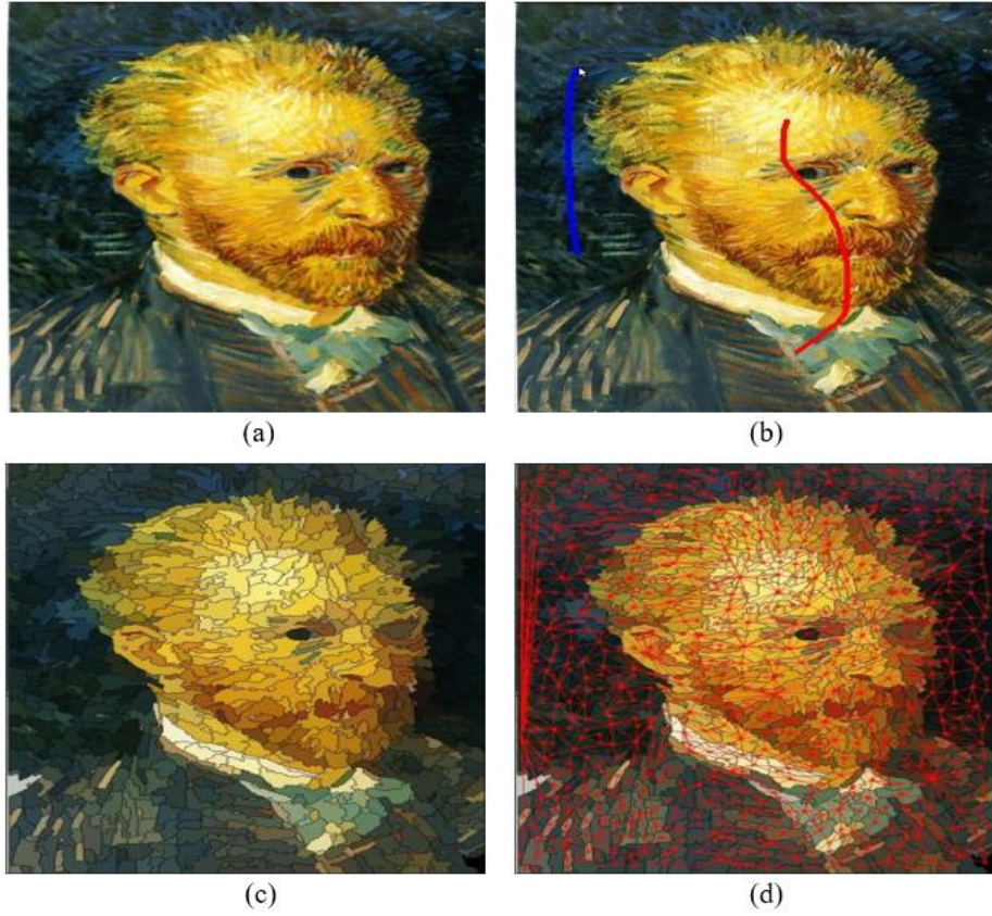
Şekil 2.7. (a) Orjinal görüntü (b) Kullanıcının ön ve arka planı seçmesi (c) Watershed ile ön bölütleme (d) Ön bölütlenen görüntünün çizge hali [28]
