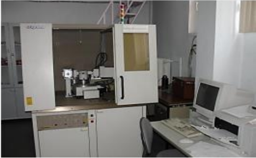
Şekil 3. 10. Faz analizlerinin yapıldığı XRD cihazı
