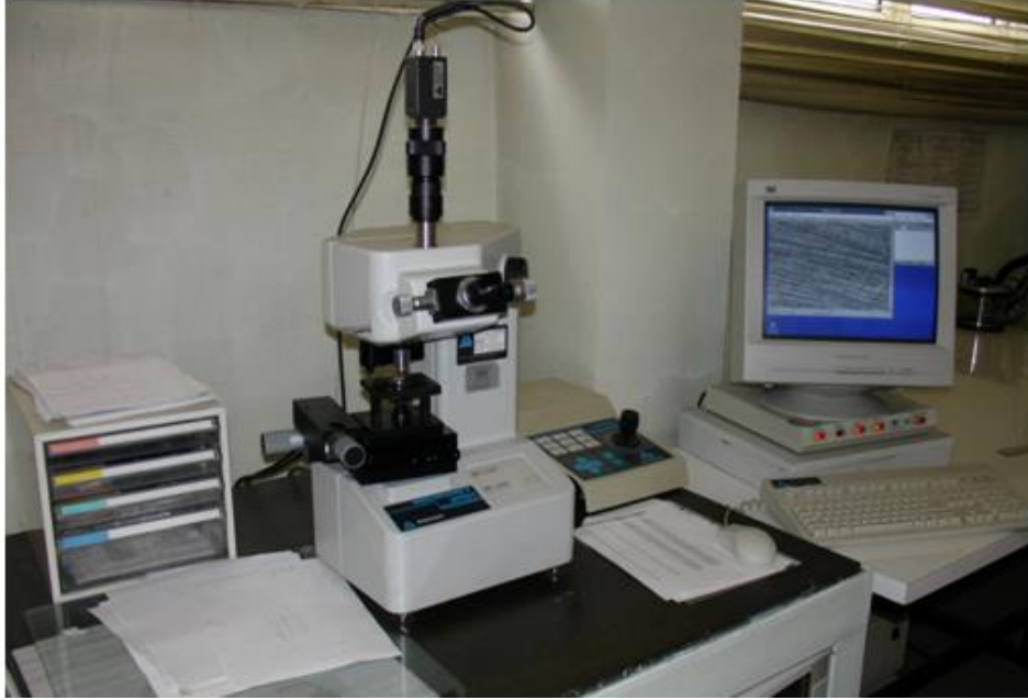
Şekil 3. 6. Buehler micromet marka mikrosertlik cihazı.
