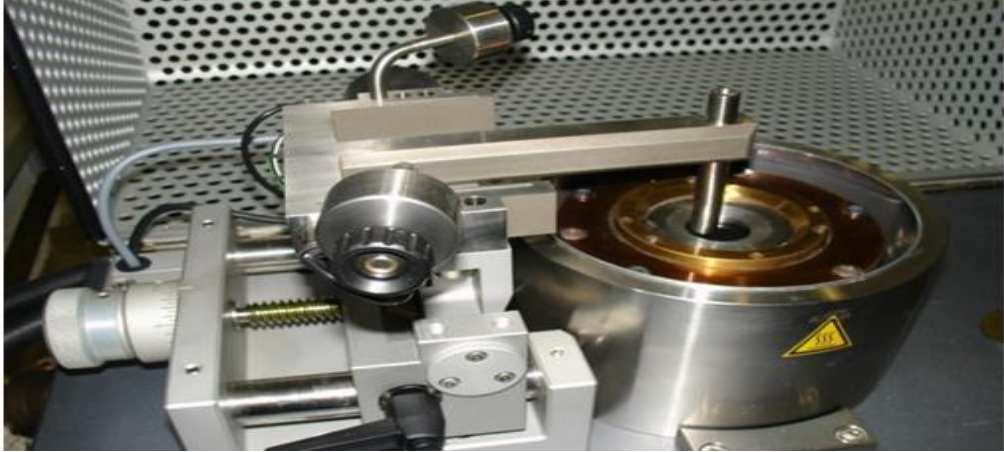
Şekil 3. 7. Tribolojik testlerin yapıldığı aşınma cihazı.
