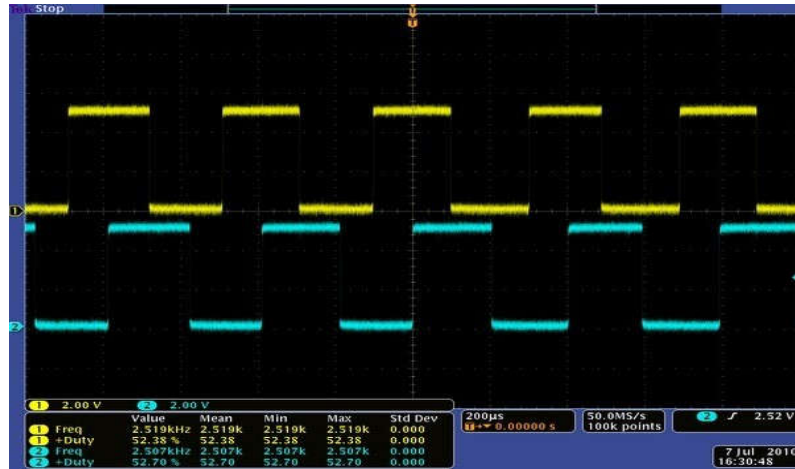
Şekil 4.3. Tekerlek dönüş sayısını ölçmek için kullanılan quadrature enkoderin 1. ve 2. kanallarında oluşan sinyallerin osiloskoptaki görünüşü
