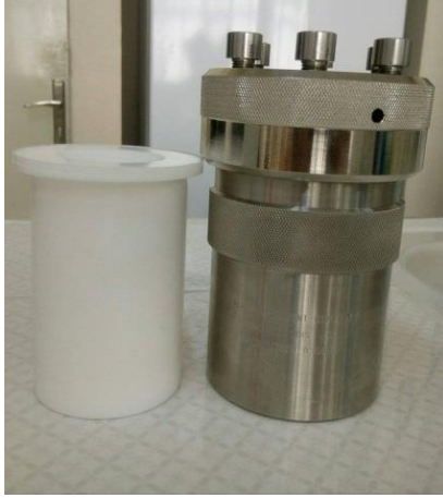
Şekil 6.2 a) Parr 4748 marka teflon kaplı paslanmaz çelik hücre, b ) Universal 320R santrifüj cihazı
