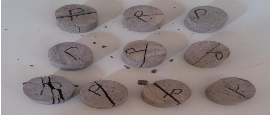
Şekil 3.20. Pazarcık (Kahramanmaraş) örneklerinin brazillian deneyinden sonraki görünümleri
