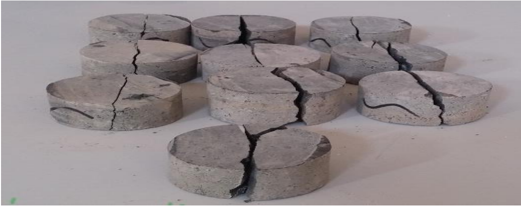
Şekil 3.21. Solhan (Bingöl ) örneklerinin Brazillian deneyinden sonraki görünümleri
