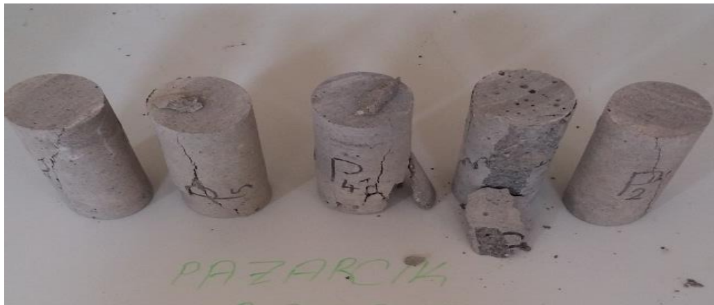
Şekil 3.17 Pazarcık (Kahramanmaraş) silindirik örneklerinin tek eksenli basınç deneyinden sonraki görünüşleri
