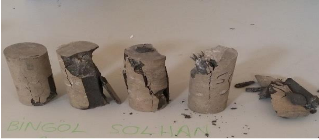
Şekil 3.16 Solhan (Bingöl) silindirik örneklerinin tek eksenli basınç deneyinden sonraki görünüşleri
