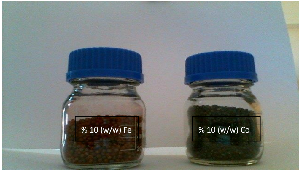
Şekil 3.2. Ağırlıkça %10 Co ve % 10 Fe katalizörleri
