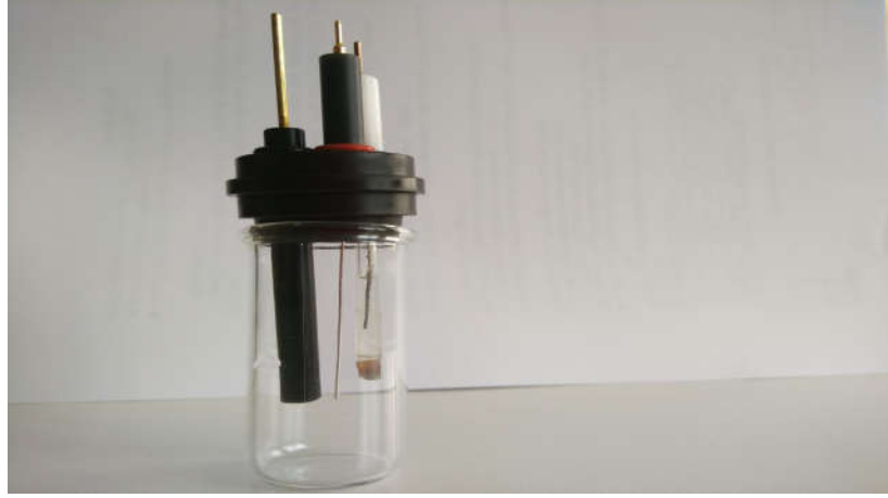
Şekil 3.2. Yardımcı elektrot, çalışma elektrodu ve referans elektrottan oluşan voltametrik hücre ve montajı
