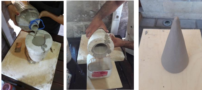
Fotoğraf 45: Alçı kalıba döküm yapılması
