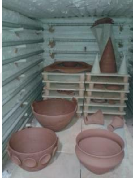
Fotoğ raf 55: İlk pişirim için çalışmaların fırına yerleştirilmesi
