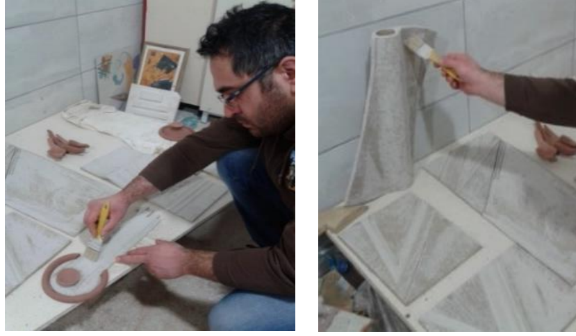
Fotoğraf 51: Seramik yüzeylerde astarlama işlemi
