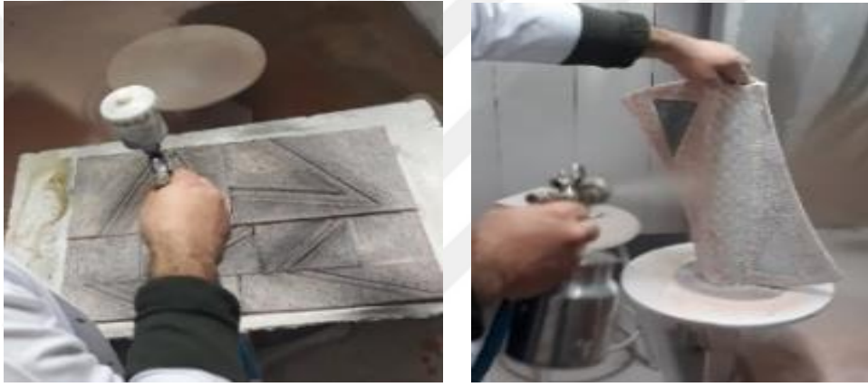
Fotoğraf 52: Püskürtme yöntemi ile sırlama
