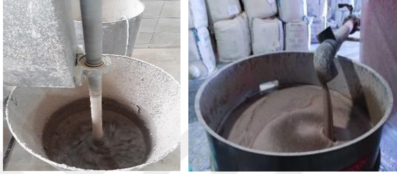
Fotoğraf 44: Döküm kilinin hazırlanması
