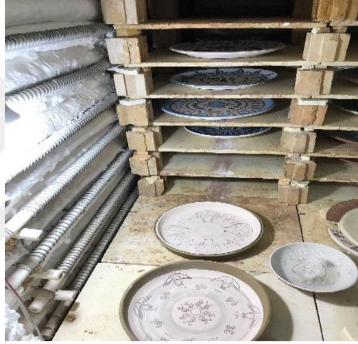
Görsel 43: Elektrikli Kamara Fırında Bisküvi Pişirimi
