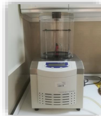
Şekil 3.4. Christ Alpha 1-2 LC plus Liyofilizatör
