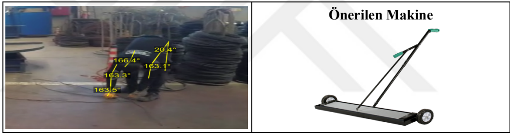
Şekil 3.19. Hurda Tellerinin Toplanması İşlemi İyileştirme Önerisi
