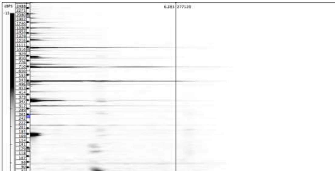
Şekil 46 - 1 numaralı tel üzerinde seslendirilen buselik perdesinin rezonatör teller üzerinde meydana getirdiği doğuşkanlar
