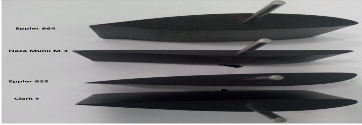
Şekil 5. 3D yazıcıda imal edilmiş kanat profiller
