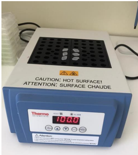
Şekil 3.10. Western Blot analizlerinde numunelerin jele yüklenmeden önce \beta -merkaptotanol ile yüksek sıcaklıkta protein yapıların lineer forma dönüşmesi için kullanılan ısıtıcı plak
