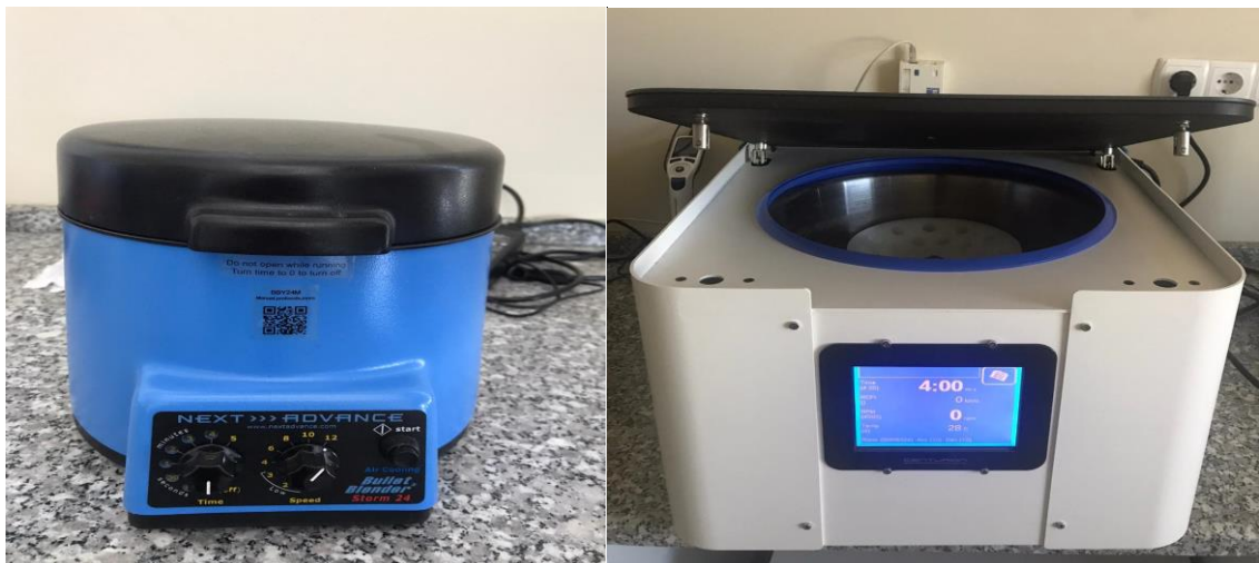
Şekil 3.11. Western Blot ve ELISA için doku homojenizasyonunda kullandığımız soğutmalı doku homojeniztör cihazı ve soğutmalı santrifüj
