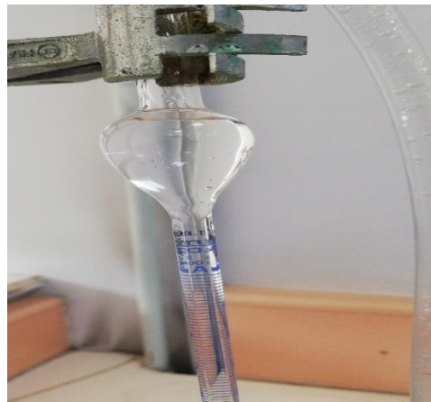
Şekil 3.7. Clavenger ile yapılan destilasyonda yağ su fazının görünümü
