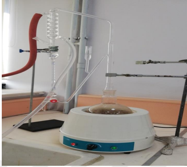
Şekil 3.6. Su destilasyonu için clavenger aleti ile kurulan sistem
