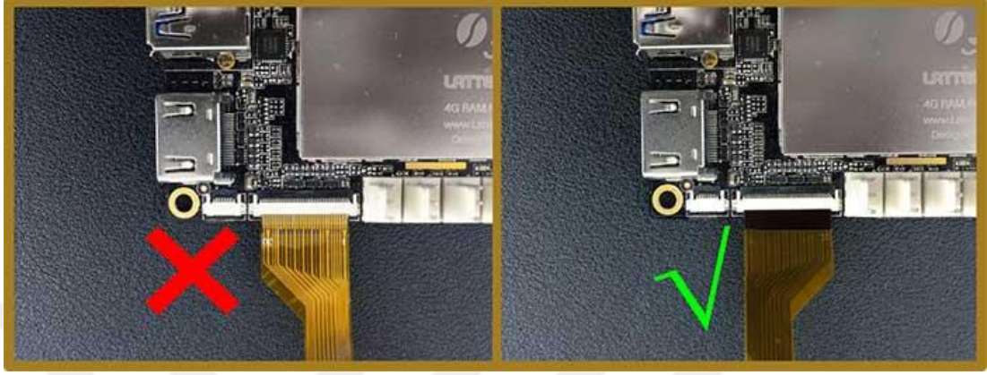
Şekil 4.30. Ekranın display konektörüne takılması [96]
