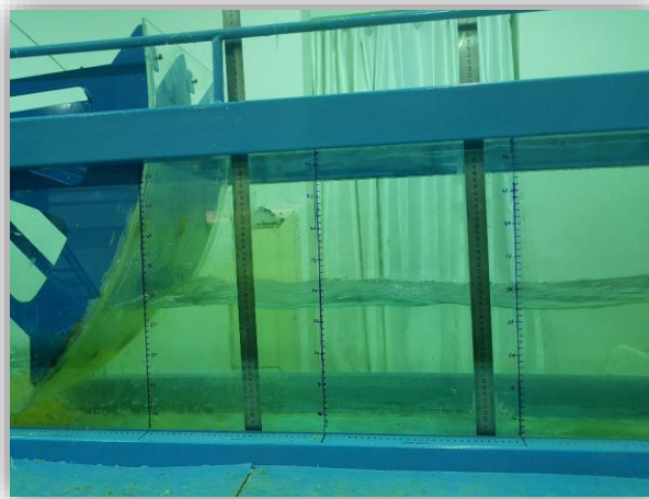
Şekil 5.1.6 : Çelik şerit cetvel ile ölçüm alınması
