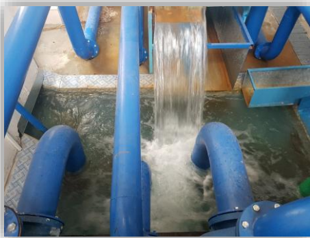
Şekil 5.1.4 : Deney düzeneğindeki su deposu ve pompanın gösterimi
