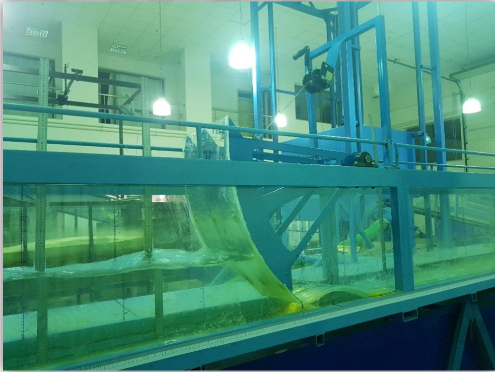
Şekil 5.1.9 : Radyal kapak düzeneğinin gösterimi
