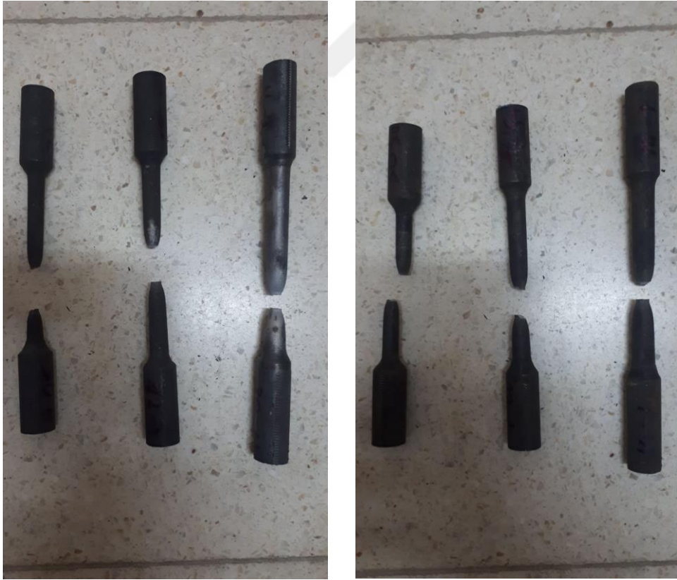
Şekil 6.5. 30 dakika hava soğutmalı ve 30 dakika su soğutmalı kopan 10,12 ve 14 mm numuneler
