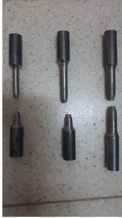
Şekil 6.4. Cihazda kopan ısılsız 10,12 ve 14 mm numuneler
