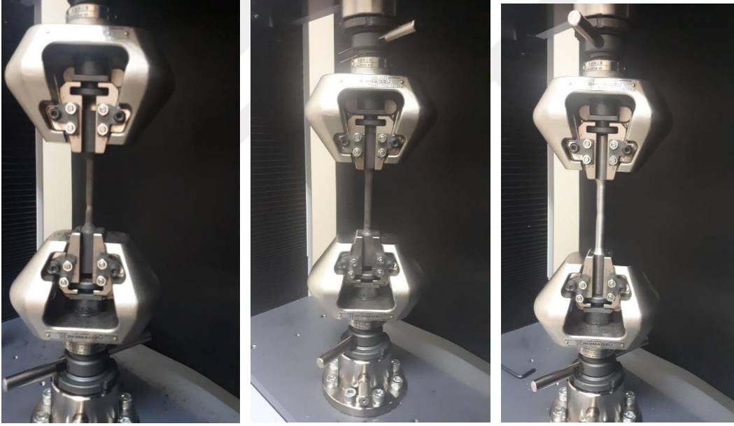
Şekil 6.3: Cihaza bağlanan 10,12 ve 14 mm numuneler
