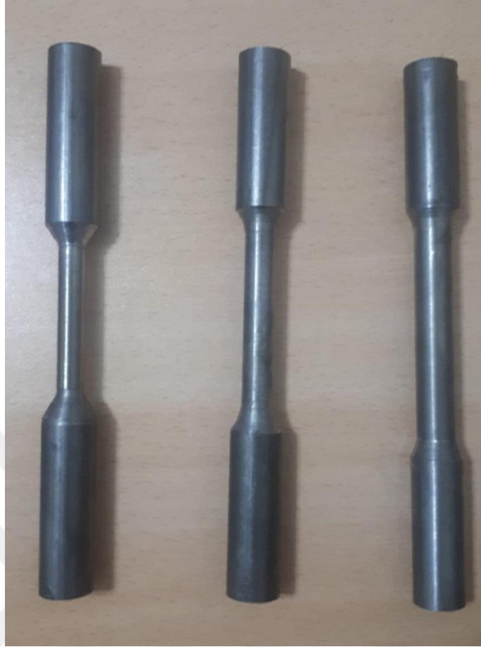
Şekil 5.4: Torna tezgahında hazırlanan 10,12 ve 14 mm numune örneği
