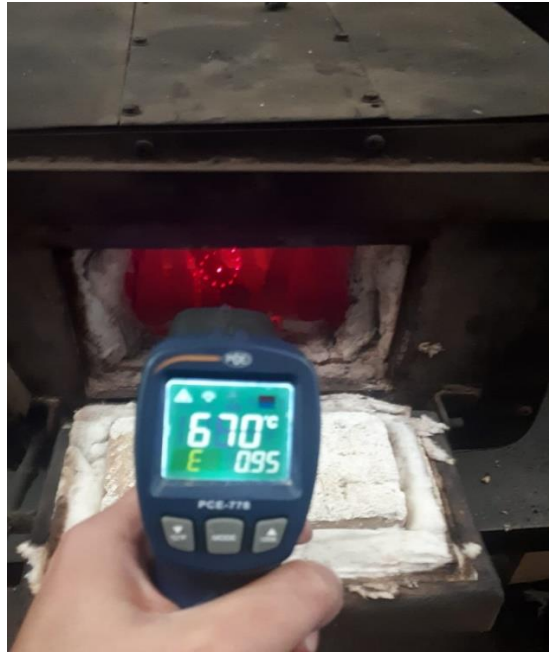
Şekil 5.6: Lazer sıcaklık ölçüm cihazı ile numune sıcaklık kontrolü
