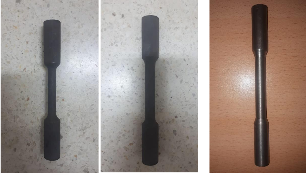
Şekil 6.2: Hazırlanan 10,12 ve 14 mm numuneler
