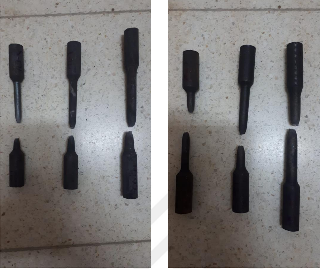
Şekil 6.6. 60 dakika hava soğutmalı ve 60 dakika su soğutmalı kopan 10,12 ve 14 mm numuneler
