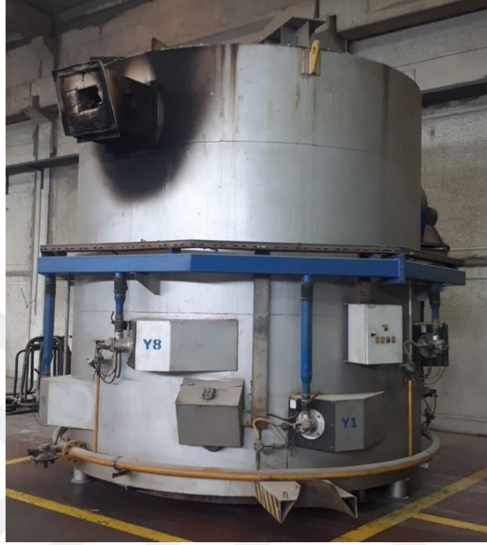
Şekil 5.9. Numunelerin Isıl İşleme Tabi Tutulduğu Fırın
