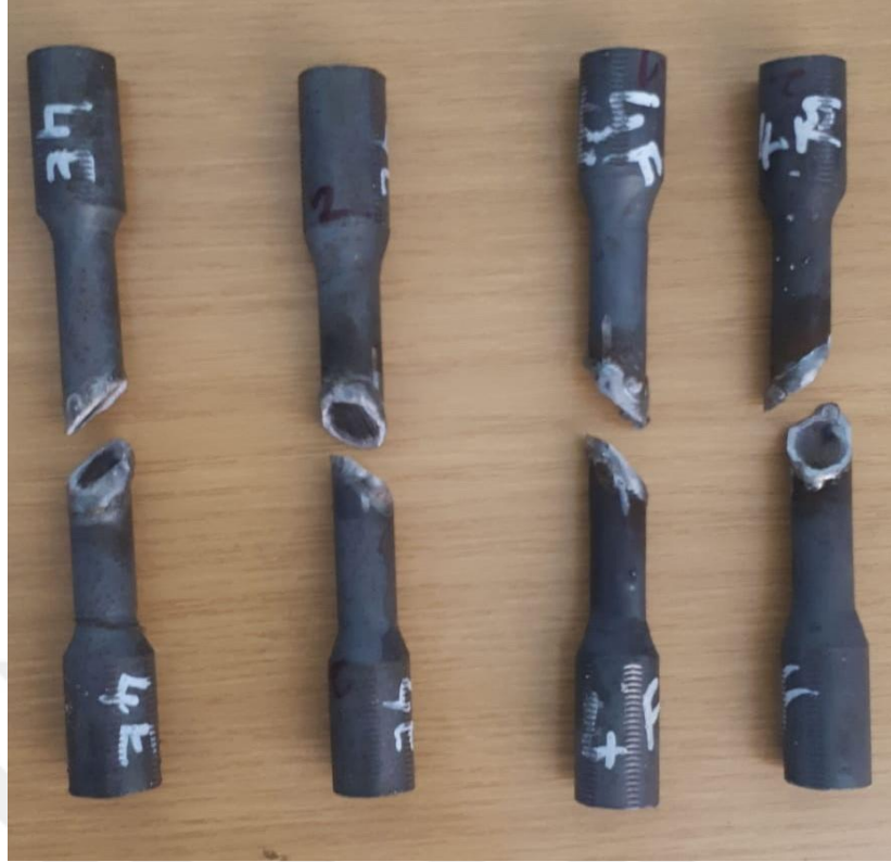
Şekil 6.31 : Açılı kesilen numunelerin deney sonrası görünümü
