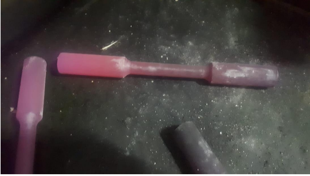
Şekil 5.8: Isıl işlem sonrası hava soğumaya bırakılan numuneler
