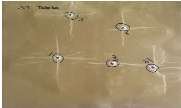
Şekil 4.7. A4 Numunesinin Atış Sonrası Ön Görünümü
