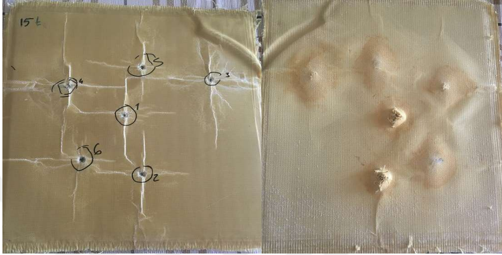
Şekil 4.3. A2 Numunesinin Atış Sonrası Ön ve Arka Görünümü
