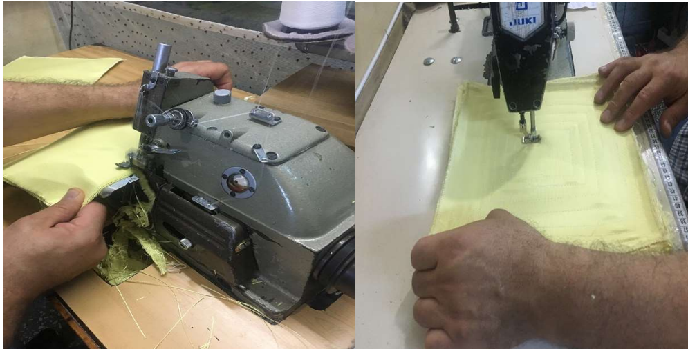
Şekil 3.7. Kevlar Overlok ve Dikim işlemleri
