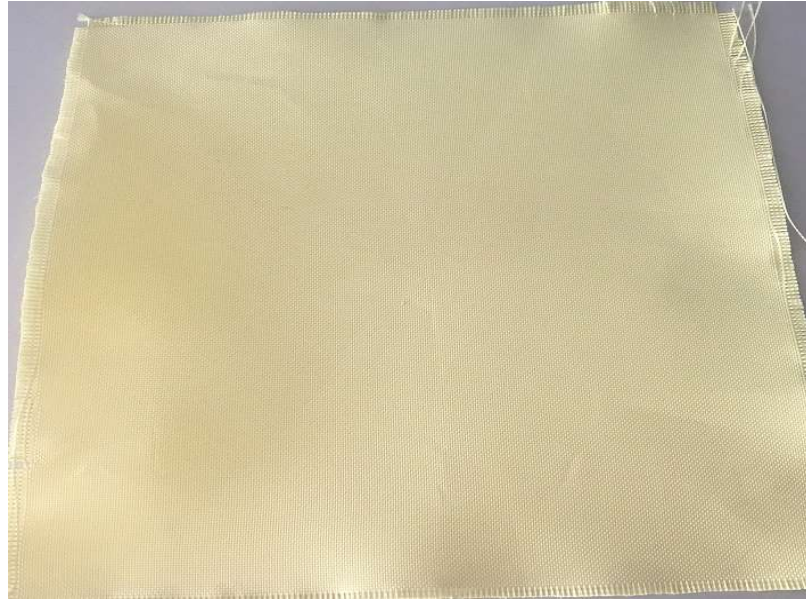
Şekil 3.3. Elektronik Makasla Kesilmiş ve Overlok Yapılmış Kevlar Kumaş
