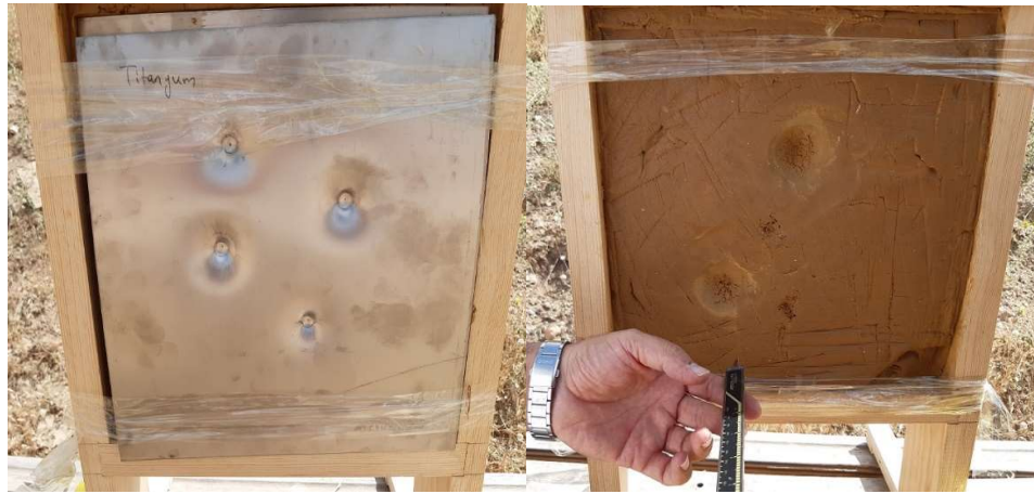
Şekil 4.13. B2 Numunesinin Atış Sonrası Ön ve Arka Macun Görünümü
