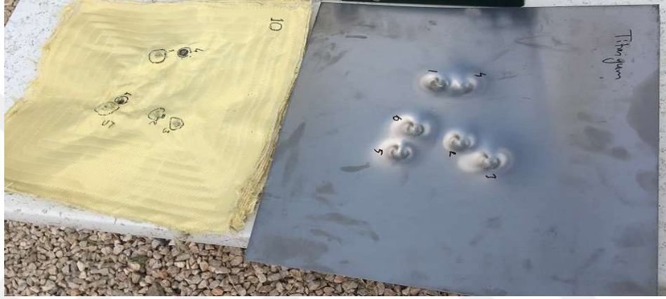
Şekil 4.15. B3 Numunesinin Atış Sonrası Ön ve Arka Görünümü
