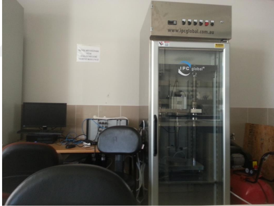
Şekil 2.25. ITSM deney cihazı
