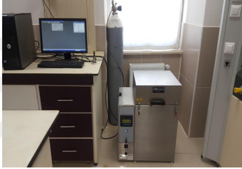
Şekil 2.12. PAV deney cihazı
