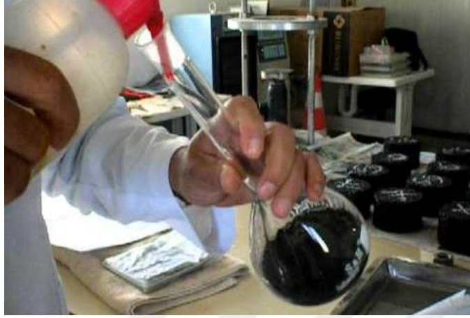
Şekil 2.10.Piknometre kabı ile özgül ağırlık tayini
