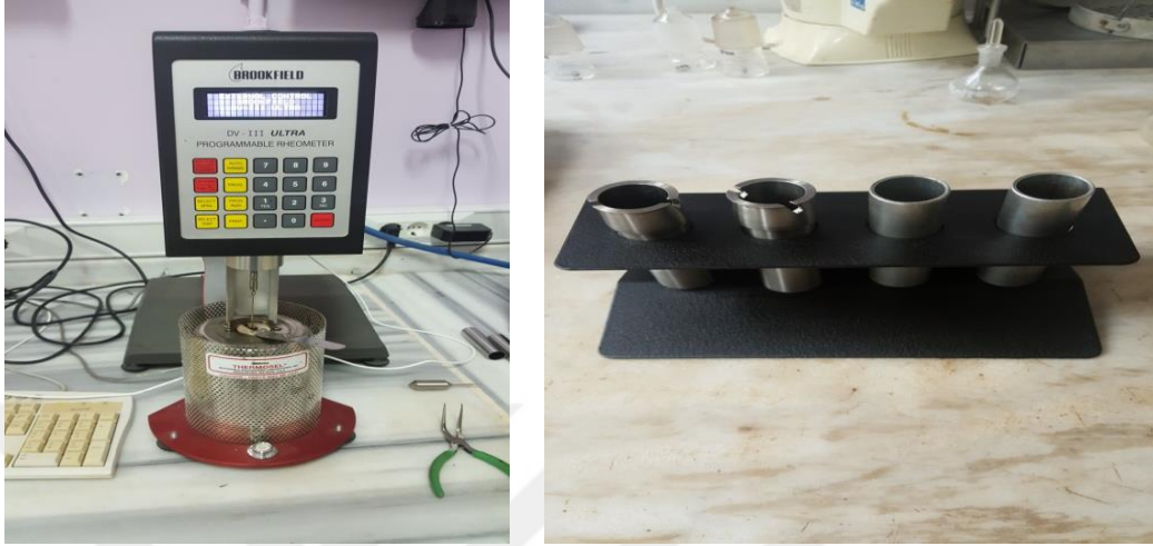
Şekil 2.13. Brookfield viskozimetresi ve tüpler
