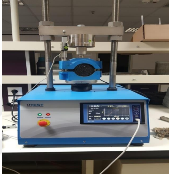
Şekil 2.22. Marshall stabilite ve akma deneyi cihazı
