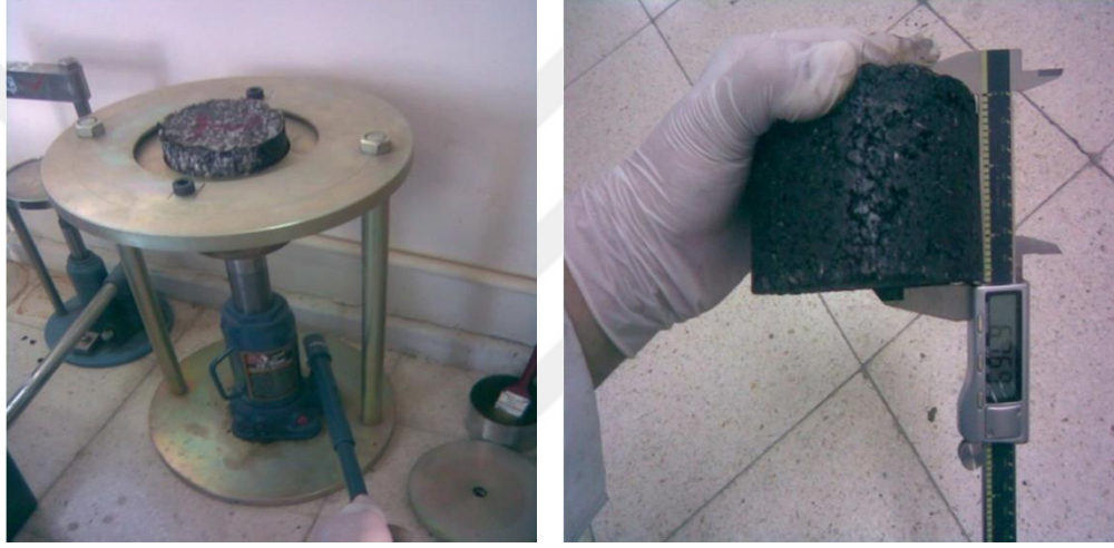
Şekil 4.21. Numunelerin krikoyla çıkarılması ve kumpasla yüksekliğin ölçülmesi
