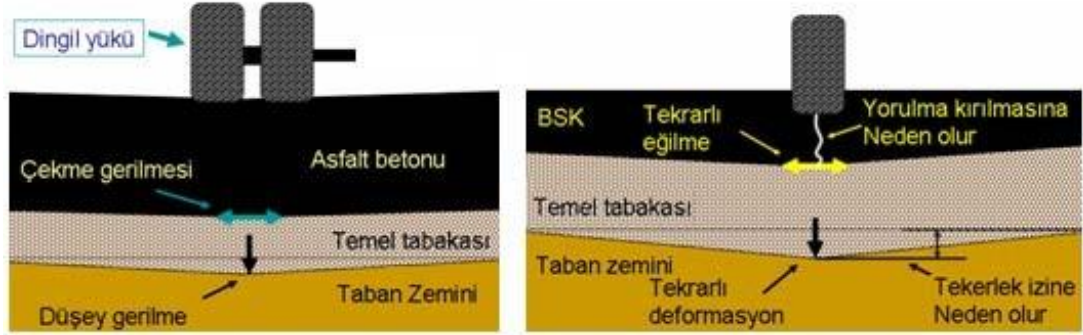
Şekil 2.30. Tipik bir esnek üstyapısı (a) ve oluşan bozulmalar (b) [1,19]
