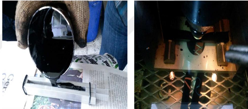
Şekil 2.15. BBR deneyi için numune hazırlanması (a) ve deneyin yapılması (b)
