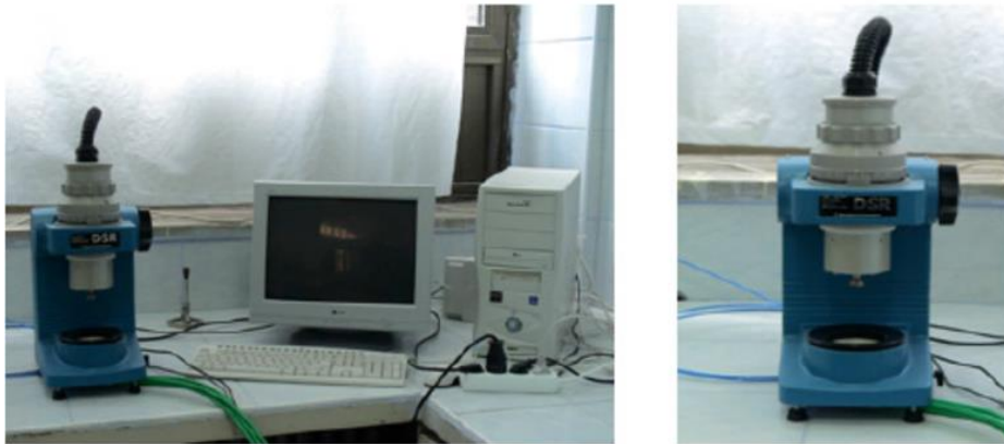
Şekil 2.17. Bohlin DSR II dinamik kesme reometresi
