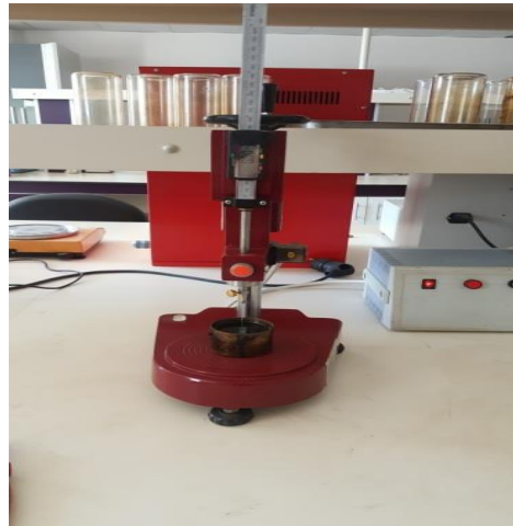
Şekil 2.6. Standart penetrasyon deney aleti
