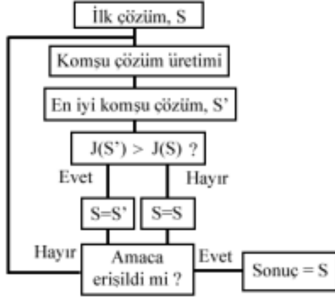
Şekil 2.1. Tepe tırmanma yöntemine ait akış diyagramı [35].
