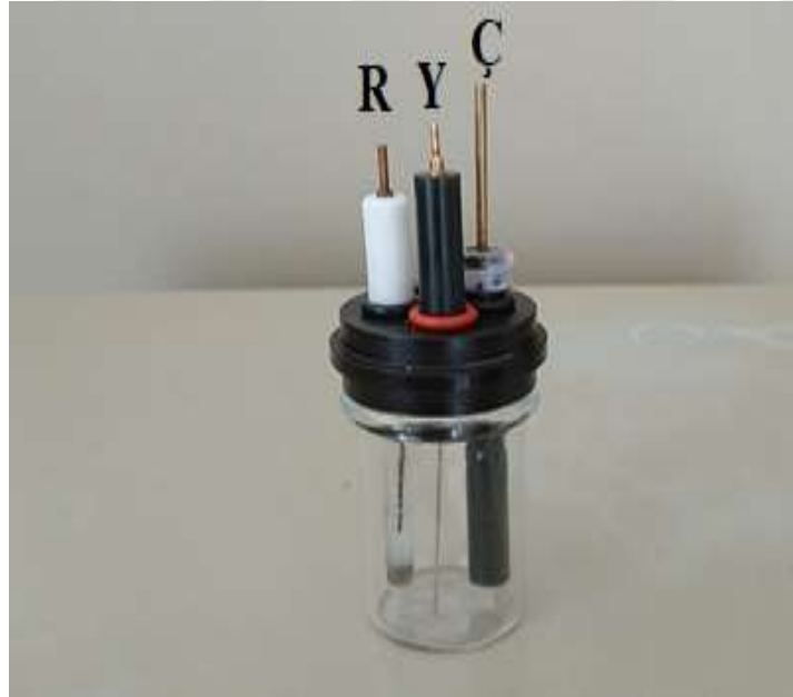
Şekil 3.2: Mikro hücre ve montajı R: referans elektrot, Ç: çalışma elektrodu, Y: yardımcı elektrot.
