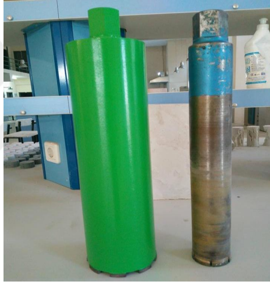
Şekil 3.8. Farklı çaplara sahip karotiyerler
