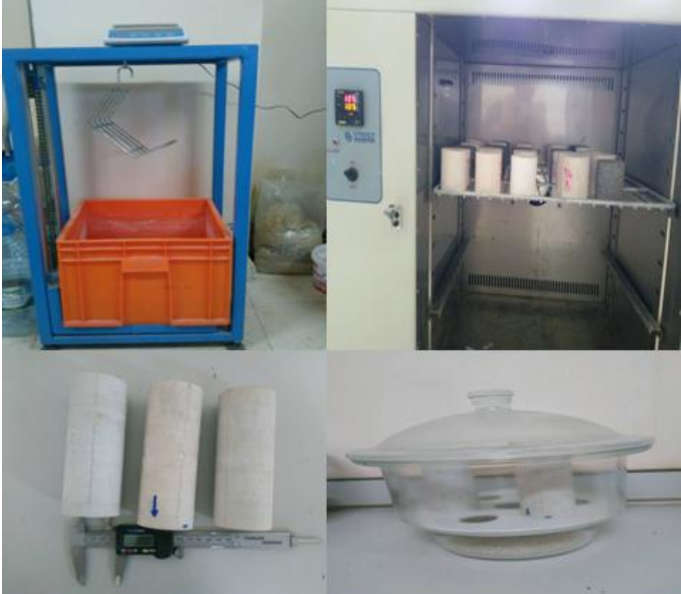
Şekil 3.7. Arşimet terazisi, etüv, kumpas ve desikatöre ait görüntü
