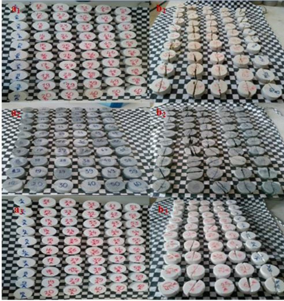
Şekil 3.18. Brazilian deneyinde kullanılan numunelerin deney öncesi (a 1 -a 3 ) ve deney sonrasında (b 1 -b 3 ) ait görüntüleri (a,b ve c sırasıyla MB, YB ve AB)
