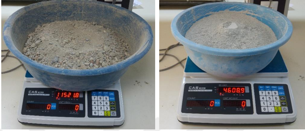
Şekil 3.64. Etüv kuru numunelerin kütlelerinin belirlenmesi
