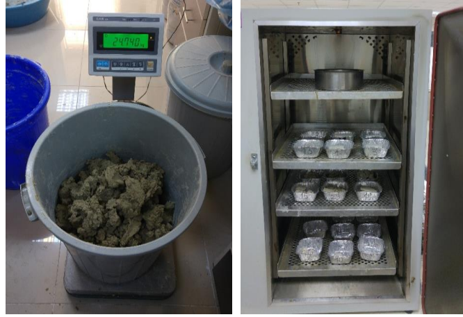
Şekil 3.68. Rijit deney tankı için gerekli yaş kohezyonlu zemin kütleinin ayarlanması (solda) ve su içeriği kontrolü (sağda)
