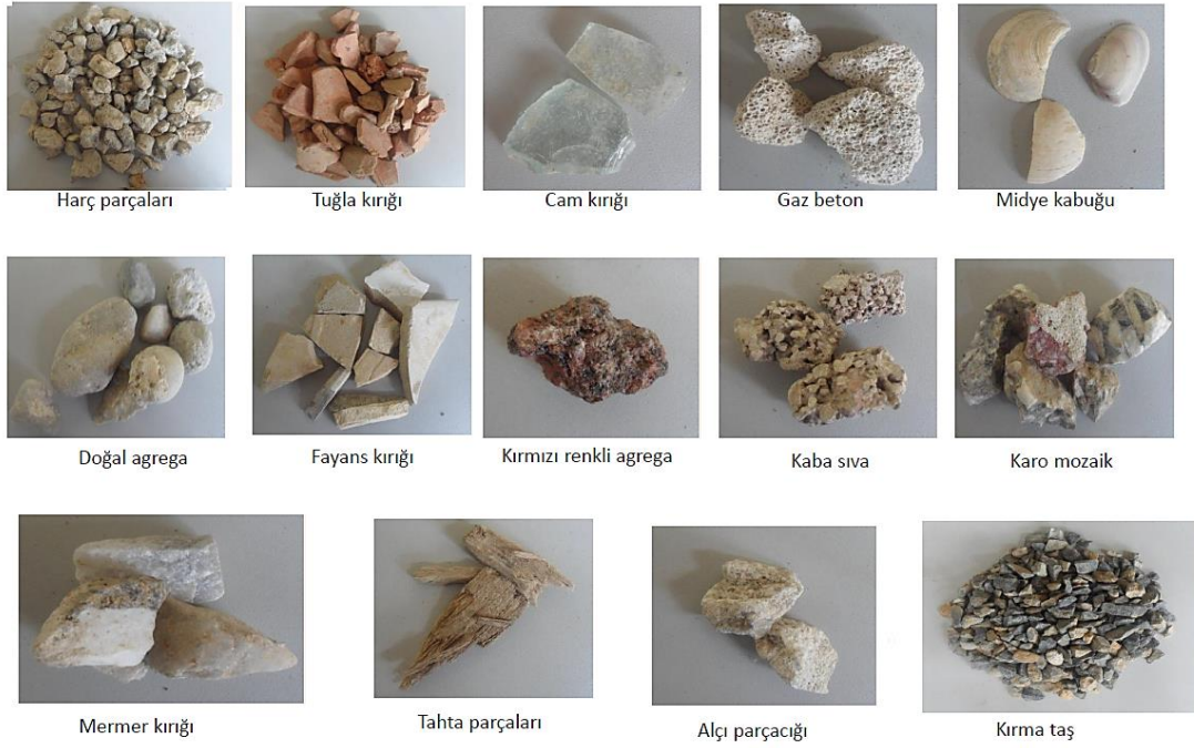
Şekil 2.10. CDW'nin geri dönüşümü sonucunda elde edilen bazı ürünler (Karaca, 2012)
