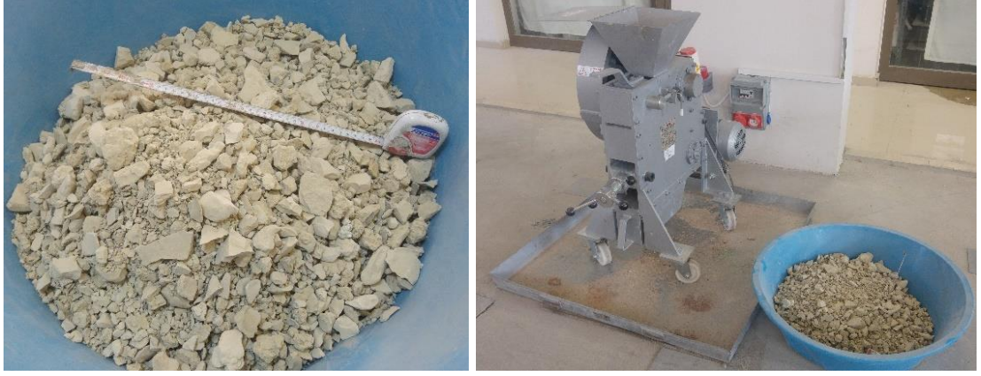
Şekil 3.10. Temin edilen kohezyonlu zemin numunesi ve çeneli kırıcı
