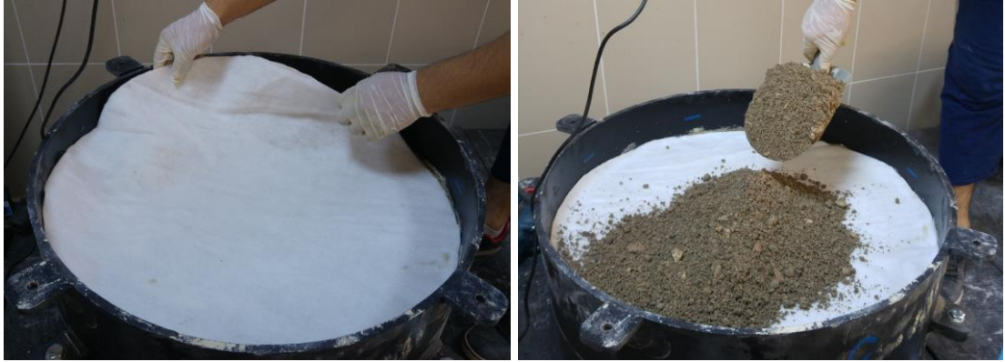
Şekil 3.74. Geotekstil yerleştirilmesi ve üzerine dolgu malzemesinin dökülmesi
