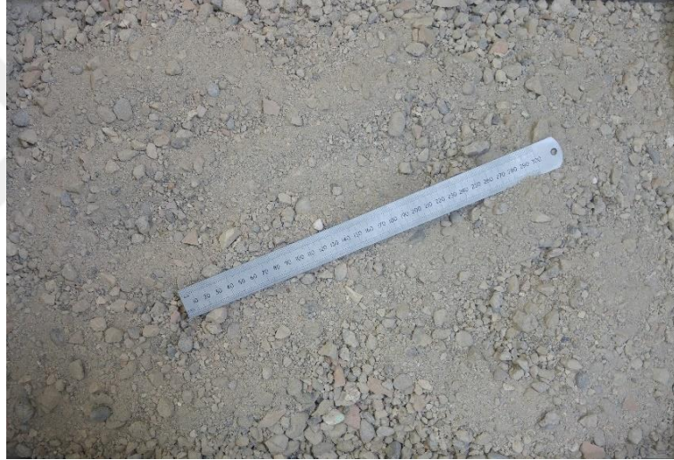
Şekil 3.4. Konkasörde kırılma işlemi sonucu oluşan 0-20 mm aralığında dane çapına sahip CDW
