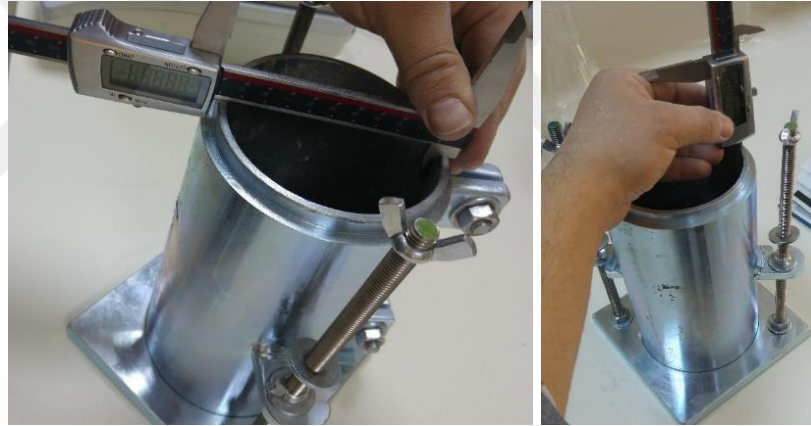
Şekil 3.56. Serbest basınç moldunun boyutlarının belirlenmesi
