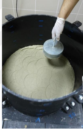
Şekil 3.69. Kohezyonlu zemin tabakalarının sıkıştırılması
