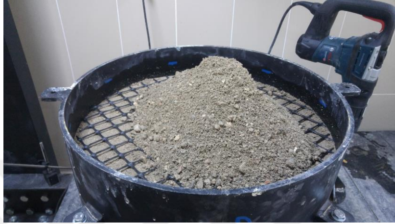
Şekil 3.75. Geogridin yerleştirilmesi ve üzerine dolgu malzemesinin dökülmesi
