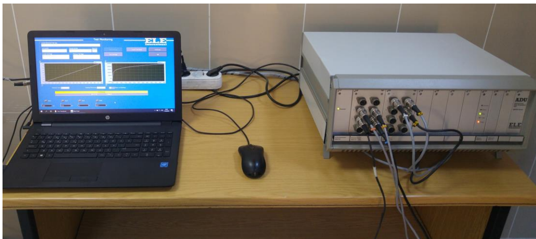
Őekil 3.46. Model ykleme deneylerinde kullanılan bilgisayar yazılımı ve veri toplama nitesi
