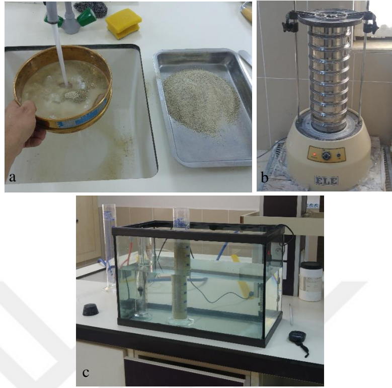
Şekil 3.12. Kohezyonlu zemin üzerinde yıkamalı elek analizi (a, b) ve hidrometre (c) deneyleri
