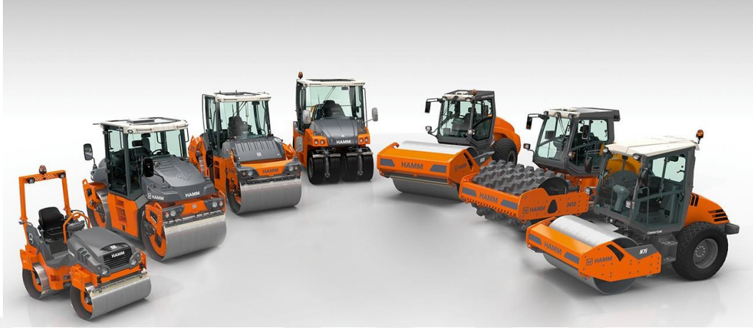
Şekil 2.15. Yüzeysel kompaksiyon için kullanılan çeşitli sıkıştırma araçları (Anonim, 2019f)
