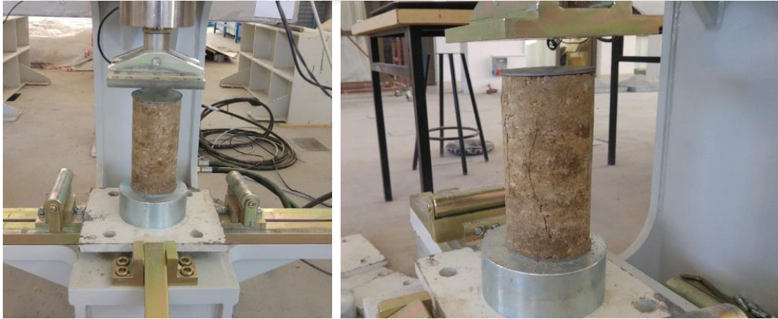
Şekil 3.61. Büyük kapasiteli yükleme sisteminde yapılan bir serbest basınç deneyinin ilk ve son anı
