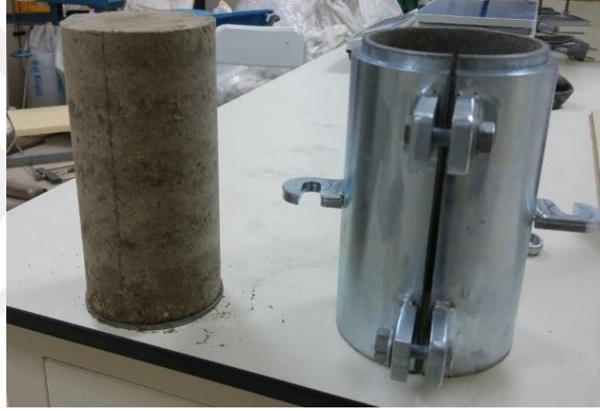
Şekil 3.59. Mold içerisinde çıkartılmış serbest basınç test numunesi
