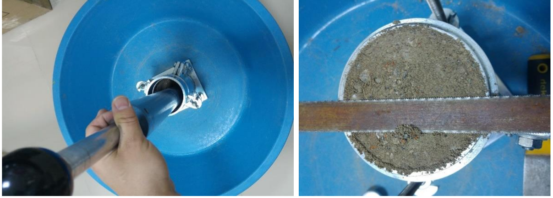
Şekil 3.58. Zeminin mold içerisinde sıkıştırılması (soldaki) ve moldun deney sonunda yakası çıkartılarak üst yüzeyinin düzeltilmesi (sağdaki)
