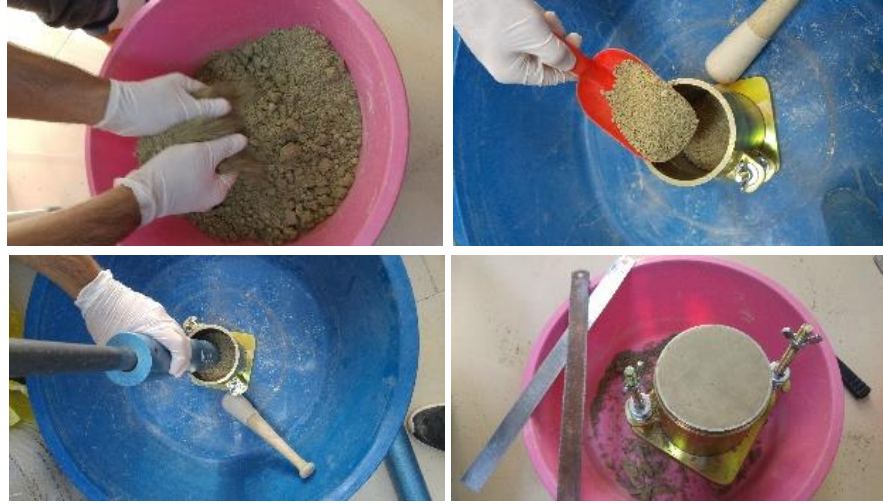
Şekil 3.15. Kohezyonlu zemin üzerinde gerçekleştirilen standart proktor deneyi
