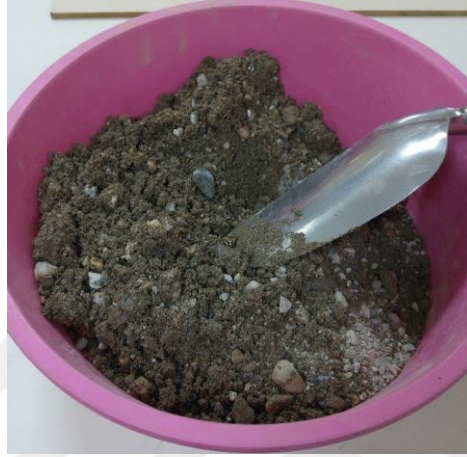
Şekil 3.50. Modifiye proktor deneyi için hazırlanan numunelerin karıştırılması
