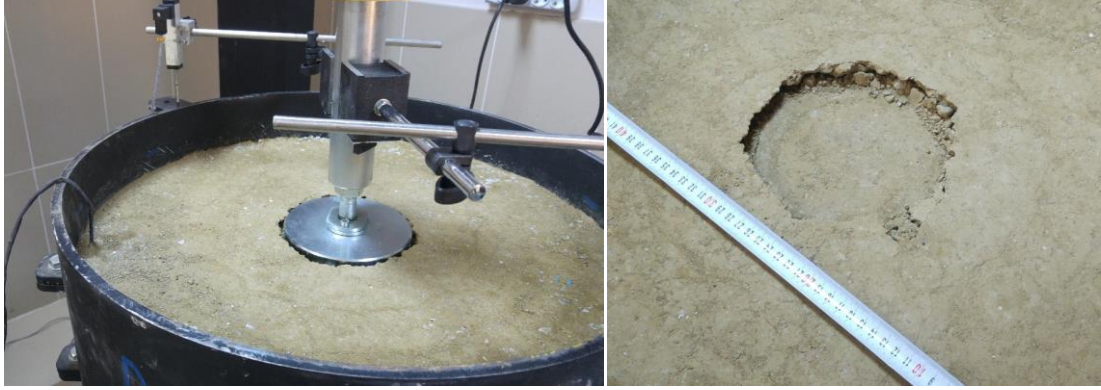
Şekil 3.78. Dolgu üzerinde yapılan model yükleme deneyinden sonra oluşan görüntü
