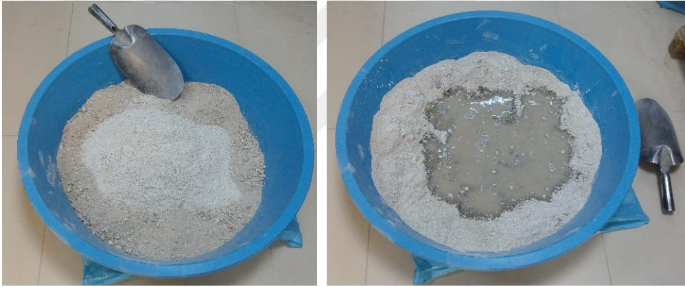
Şekil 3.65. Etüv kuru numunelerin karıştırılması ve AAÇ eklenmesi
