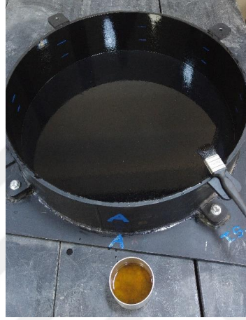
Şekil 3.67. Rijit deney tankının yağlanması
