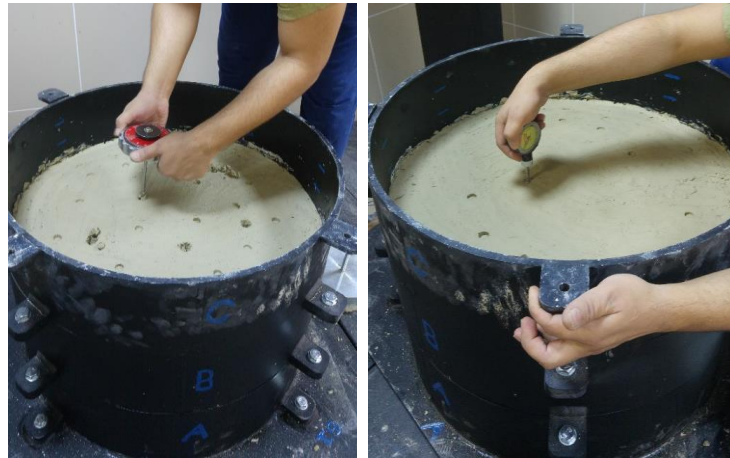
Şekil 3.70. Kohezyonlu zemin tabakasının sıkıştırma işlemi tamamlandıktan sonra vane (solda) ve penetrometre (sağda) deneylerinin gerçekleştirilmesi
