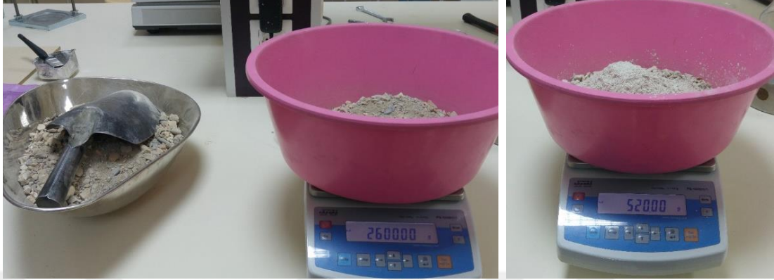
Şekil 3.54. CDW'nin ve puzolan katkının kütlelerinin belirlenmesi
