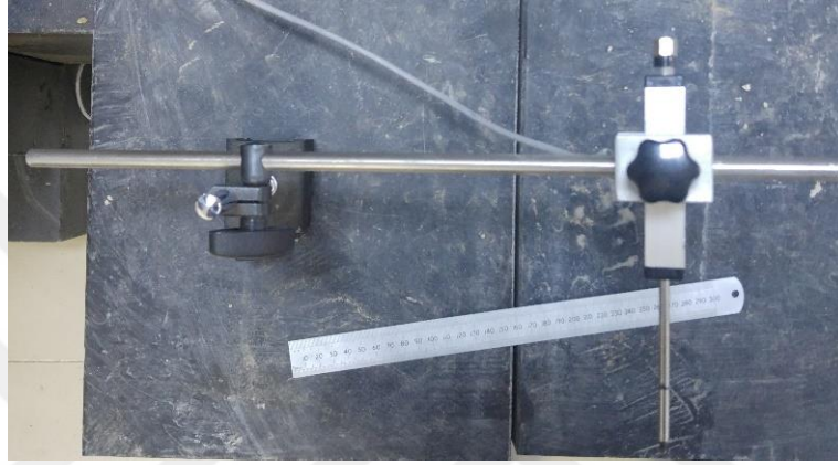
Şekil 3.43. Model yüklem deneyinde kullanılan deplasman ölçer (LVDT)
