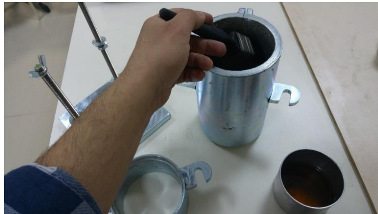
Şekil 3.57. Serbest basınç moldunun yağlanması
