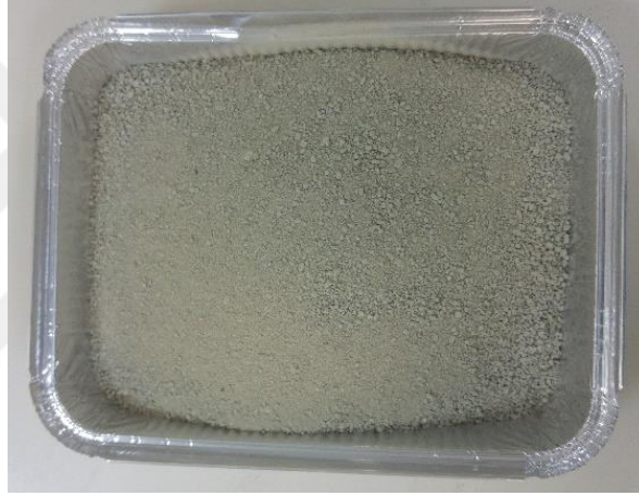
Şekil 3.11. Kohezyonlu zeminin çeneli kırıcı ile kırıldıktan sonraki hali
