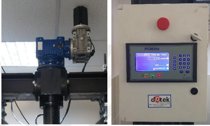
Şekil 3.38. Yüklemeye motoru (solda) ve yük kontrol paneli (sağda)
