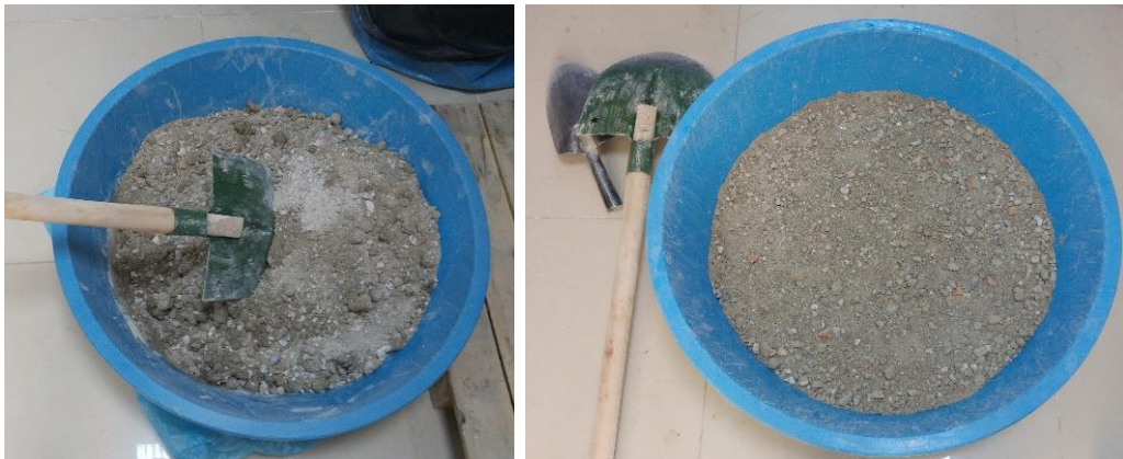
Şekil 3.66. Etüv kuru numunelerin AAÇ ile karıştırılması
