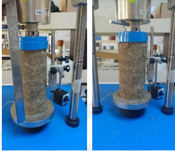
Şekil 3.60. Düşük kapasiteli yükleme sisteminde yapılan bir serbest basınç deneyinin ilk ve son anı
