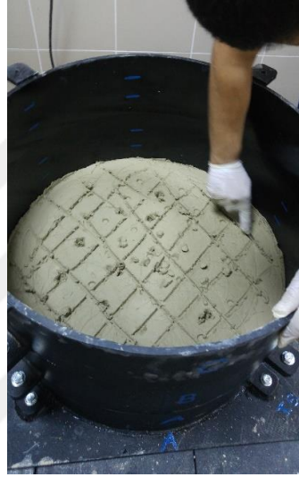
Şekil 3.71. Tabakanın bir sonraki tabaka ile kenetlenmesi için çizilmesi
