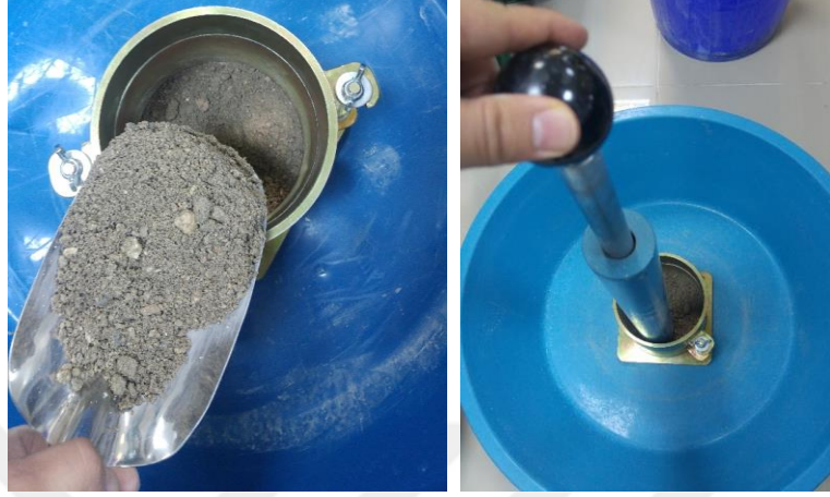
Şekil 3.52. Zemin numunesinin modifiye proktor molduna yerleştirilmesi ve sıkıştırılması
