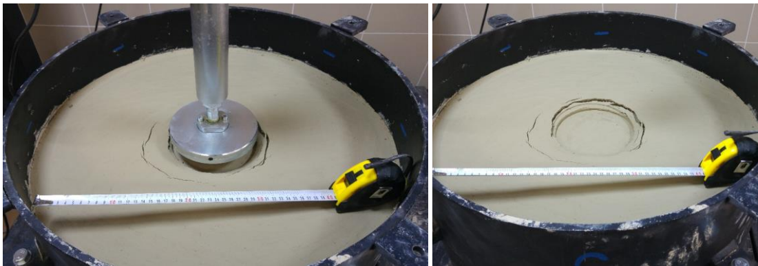
Şekil 3.77. Zayıf zemin ortamı üzerinde yapılan model yükleme deneyinden sonra oluşan görüntü
