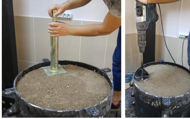
Şekil 3.73. Dolgu tabakalarının sıkıştırılması işlemleri
