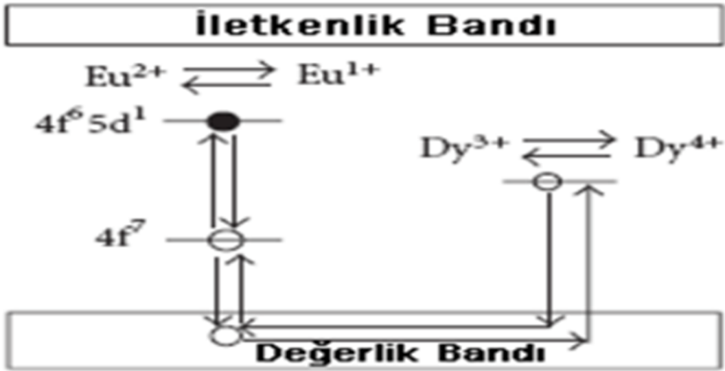
Şekil 3.5. Fosforesans malzemenin eletron düzeyinde taşımayla olan ışımının gösterimi
