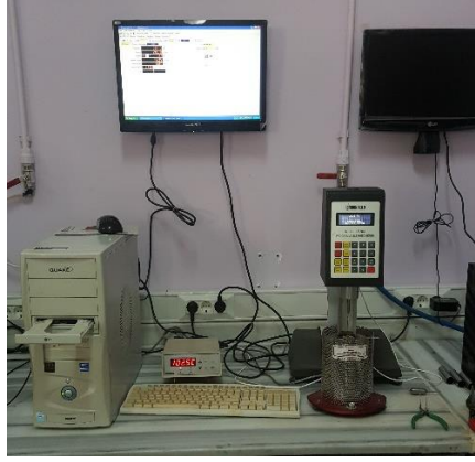
Şekil 2.16 : RV cihazı ve numunelerin doldurulduğu tüpler.
