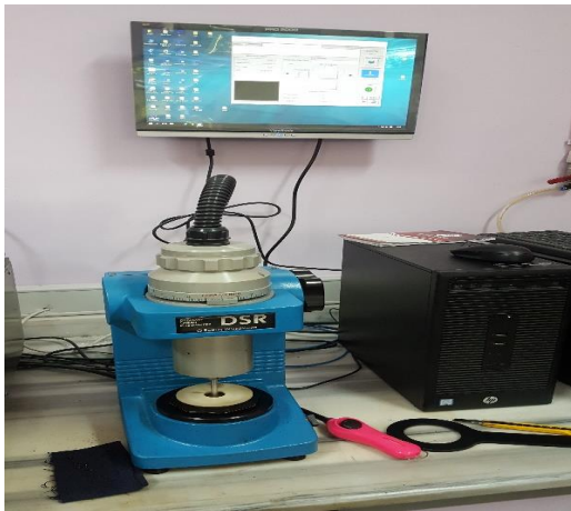
Şekil 2.11 : DSR cihazı ve hazırlanan numuneler.
