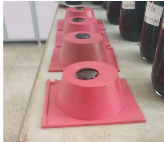
Şekil 2.11 : DSR cihazı ve hazırlanan numuneler.
