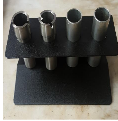
Şekil 2.16 : RV cihazı ve numunelerin doldurulduğu tüpler.
