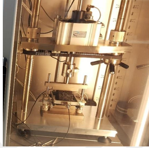
Şekil 2.25 : ITSM deney düzeneği.
