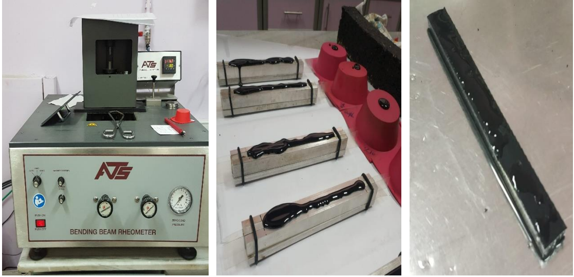
Şekil 2.14 : BBR cihazı, kalıplar ve hazırlanan numuneler.
