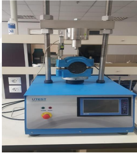
Őekil 2.22 : Marshall Stabilite ve Akma Cihazı.
