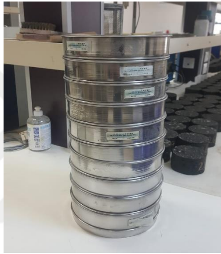
Şekil 2.2 : Elek Analizi Deney Düzeneği [47]
