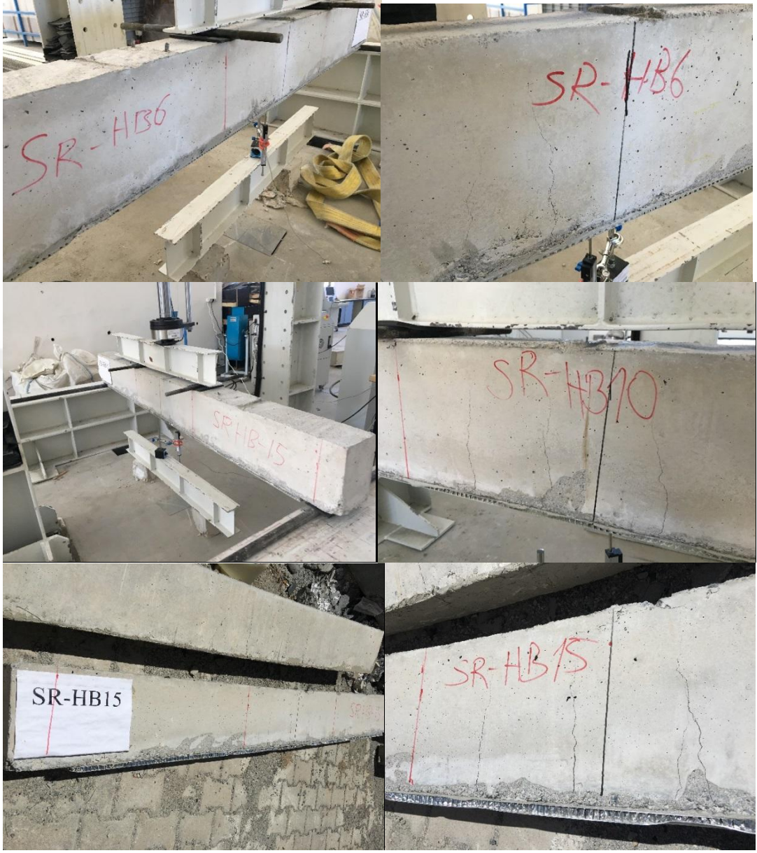
Şekil 4.8. SR-HB6, SR-HB10 ve SR-HB15 deney sonrası fotoğrafları
