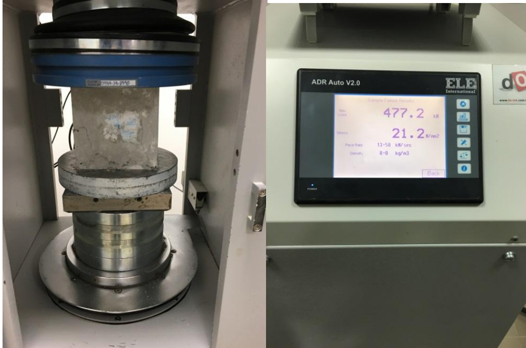
Şekil 4.1. Beton numunesinin test görüntüsü
