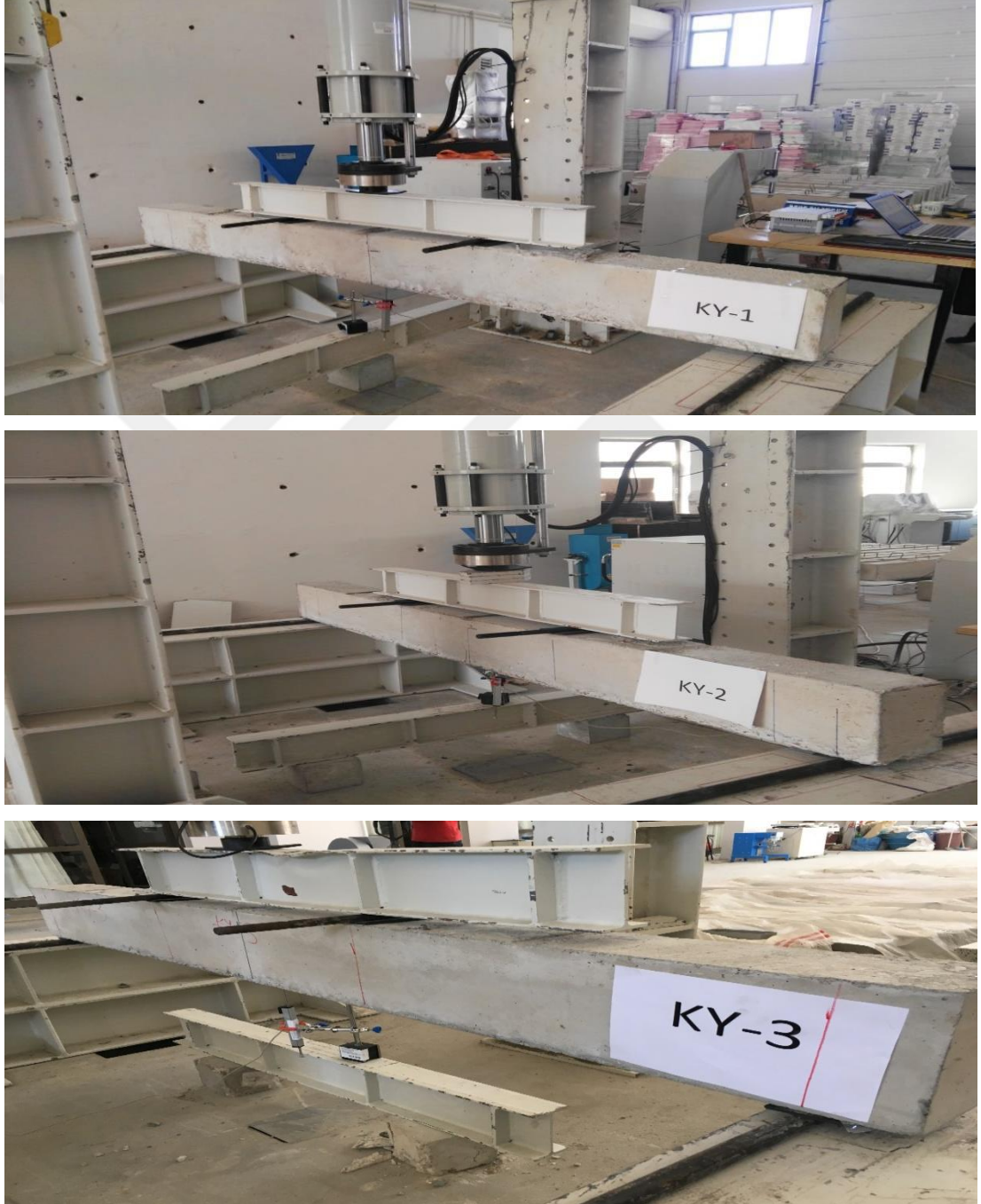
Şekil 4.4. Güçlendirilme işlemi yapılmamış kirişlerin yükleme öncesi fotoğrafları
