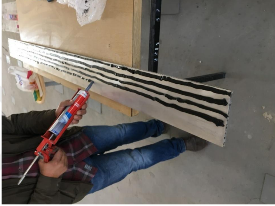
Şekil 3.17. Panel üzerine poliüretan bazlı yapıştırıcı uygulanması
