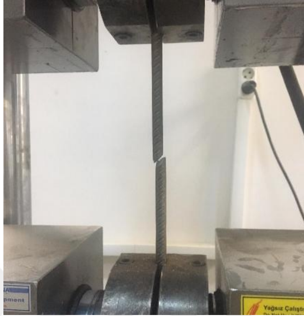
Şekil 4.2. Donatı çeliği çekme deneyi (Koç, 2018)
