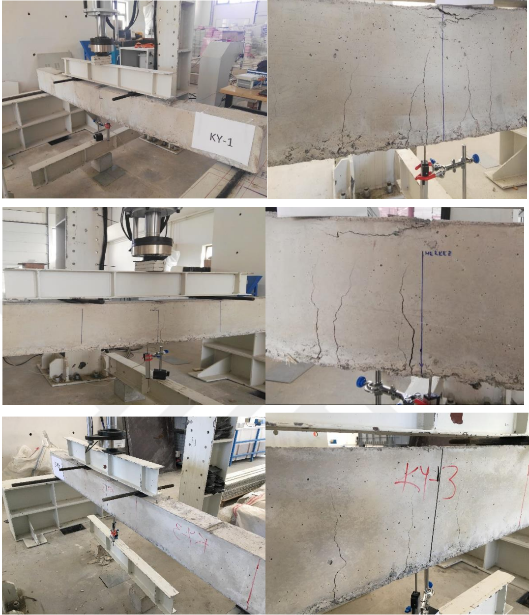
Şekil 4.5. Güçlendirilme işlemi yapılmamış kirişlerin yükleme sonrası fotoğrafları
