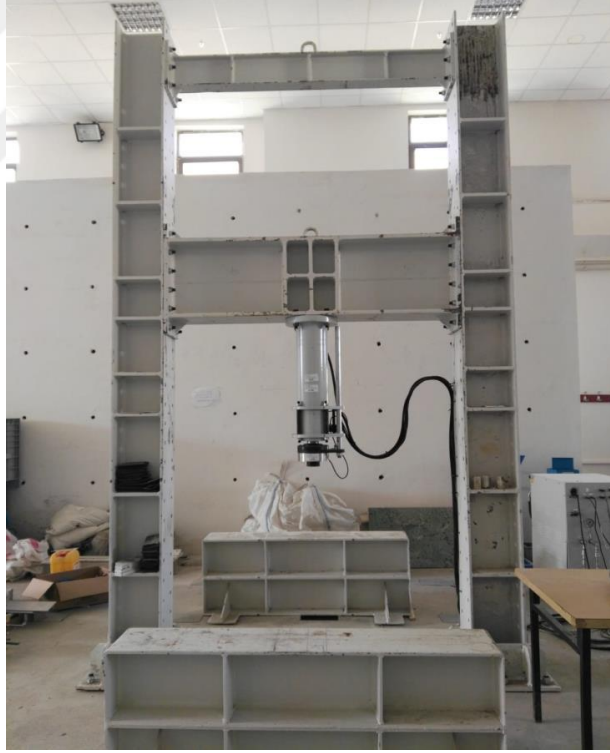
Şekil 3.22. Eğilme Deney Düzeneği
