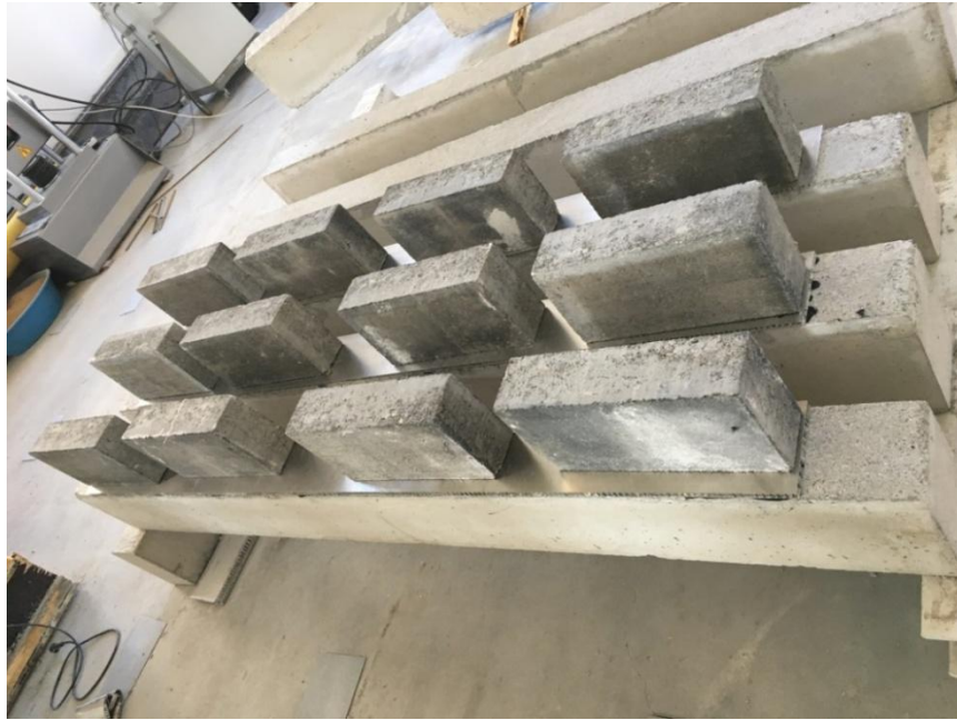
Şekil 3.18. Panelin kirişe yüzeyine sıkıştırılması
