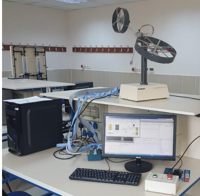
Şekil 6.1. Çift motorlu çok giriş çok çıkışlı sistem deney düzeneği (Feedback Instruments)
