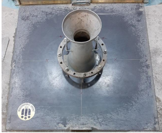
Şekil 3.6 J-halkası deney aparatı
