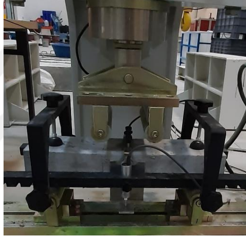
Şekil 3.11 Dört noktalı eğilme testi düzeneği
