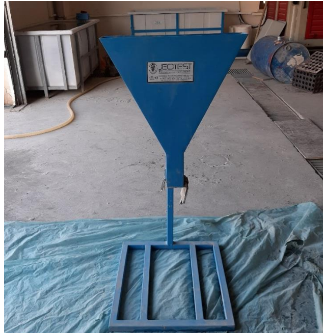
Şekil 3.7 Deneylerde kullanılan V-hunisi deney aleti
