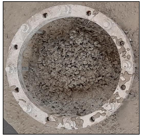
Şekil 4.8 Karma lifli karışımlara ait J-halkası deneyi görselleri
