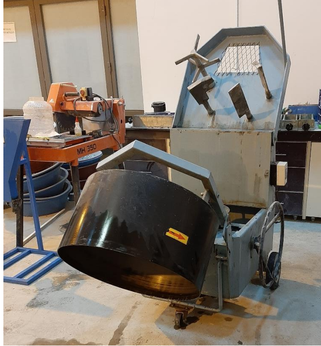
Şekil 3.3. Karışımlarda kullanılan pan tipi mikser
