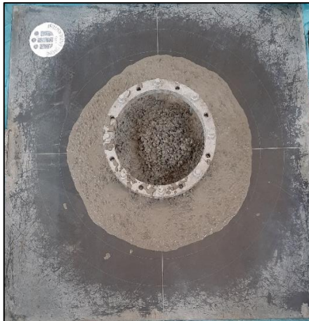
Şekil 4.8 Karma lifli karışımlara ait J-halkası deneyi görselleri
