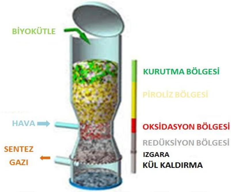
Şekil 2.2. Reaktör içerisinde gazlaştırma aşamaları [31]
