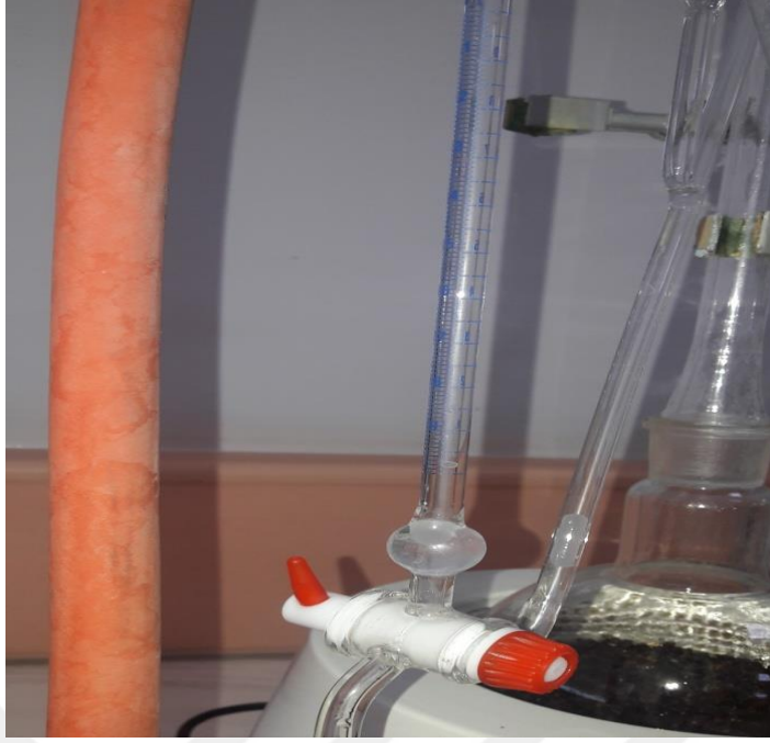
Şekil 3.6. (Clevenger) Ekstraksiyon ile uçucu yağ görüntüsü
