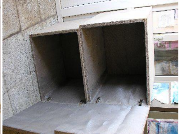
Şekil 1b. İçi Alimuyum kaplı Faraday kafesleri.
