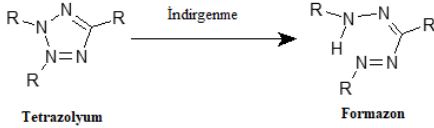
Şekil 3.2. Tetrazolyum tuzunun formazona dönüşümü.
