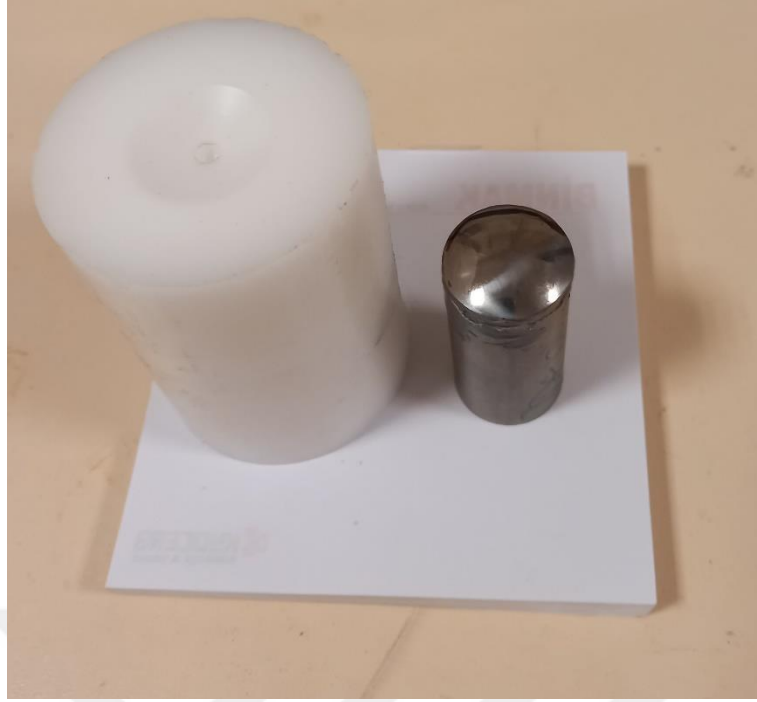
Şekil 2.16: Aşınma deneyi için tasarlanmış UHMWPE bileşen ve serbest şekilli numune.
