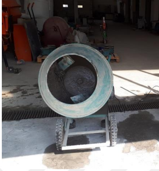
Şekil 3.3 : Kullanılan düşey eksenli mikser.
