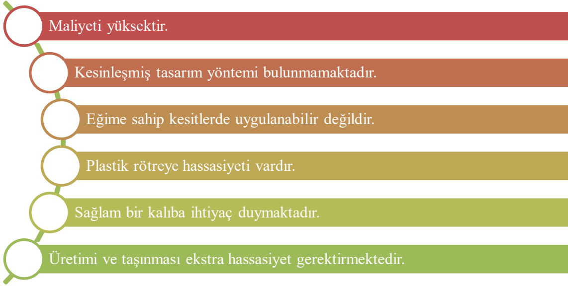
Şekil 2.3 : Kendiliğinden yerleşen betonların dezavantajları.
