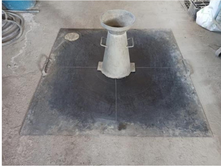
Şekil 3.8 : Çökme-yayılma ve T 500 süresi testi.
