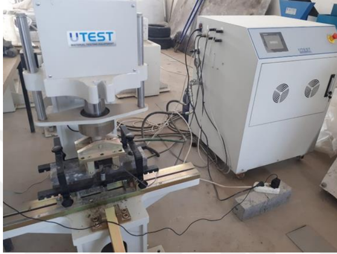
Şekil 3.12 : Eğilmede çekme dayanım testi.
