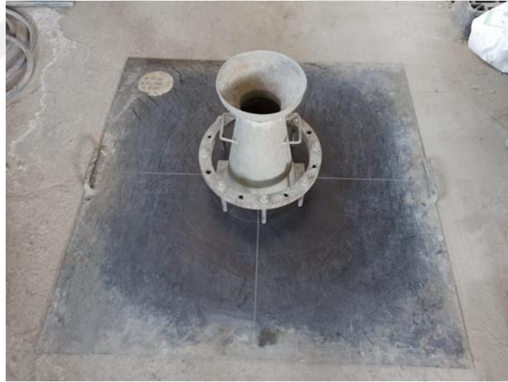
Şekil 3.9 : J-halkası ve T_{500} süresi testi.
