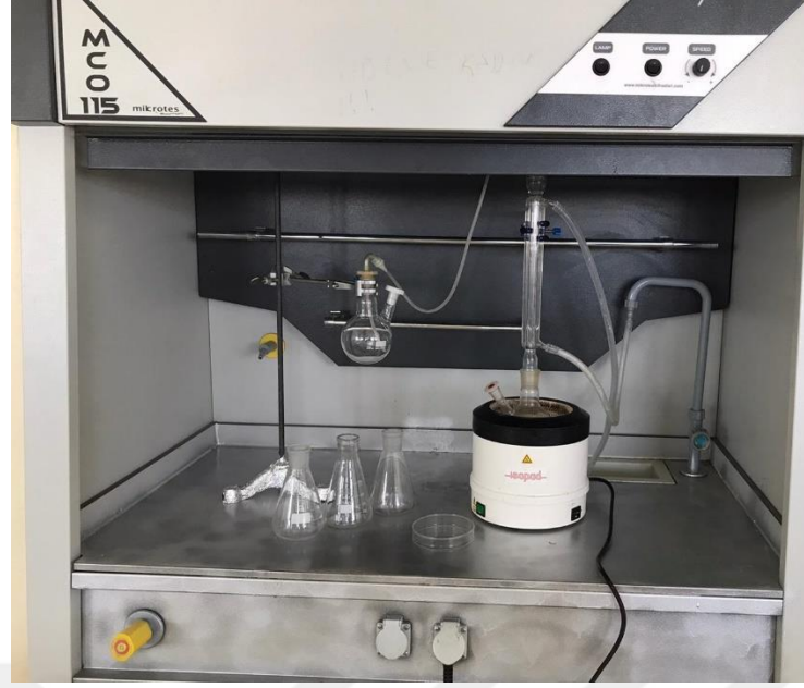
Şekil 3.3 : Çürük Asitten HCl'i deriştirerek Geri Kazanım İçin Kullanılan Adi Destilasyon Düzenegi.
