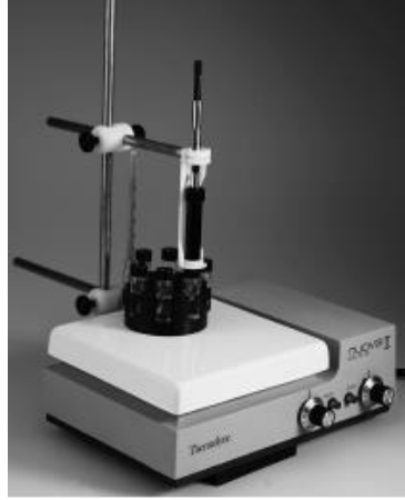
Şekil 3.4: Headspace-SPME enjeksiyon standı (Saraç-Yüce, 2012).
