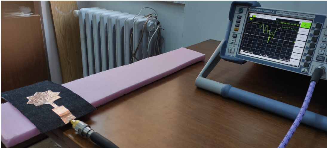
Şekil 5.26. Vektör Network Analizör (VNA) cihazı
