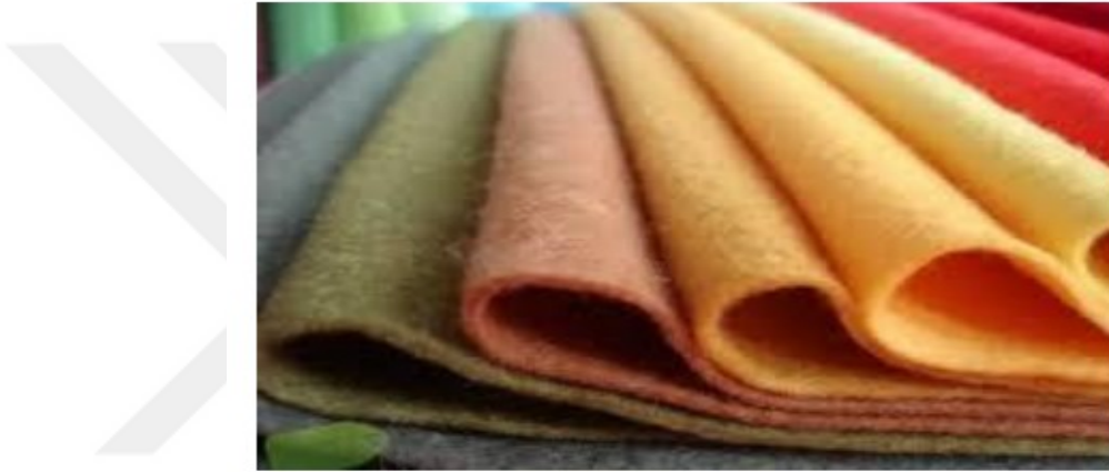
Şekil 2.8. Dielektrik taban olarak kullanılabilen keçe (Albaraqdar, 2018)
