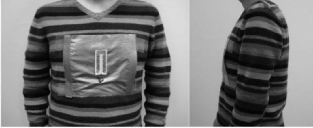
Şekil 2.5. İnsan vücudu üzerinde giyilebilir anten (Albarraqdar, 2018).
