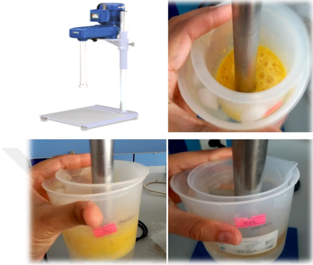
Şekil 3.5 : Ultraturax cihazı ve merkez materyallerin homojenizasyonu.
