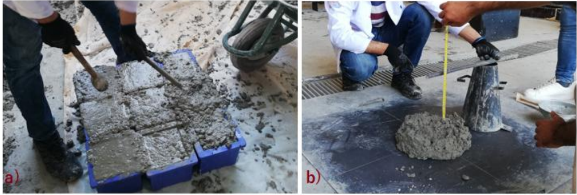
Şekil 3. 1 Tze beton özellikleri; a) Küp kalıplara doldurulma işlemi, b) Slump deneyi
