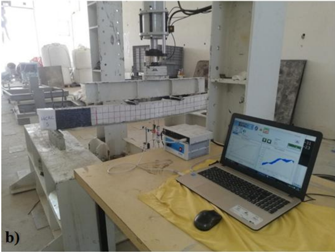
Şekil 3.9 a) Ön görünüş (çerçeve sistemi), b) Test prosedürü (dört noktalı eğilme testi)
