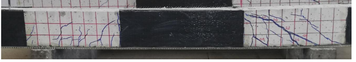
b) B Grubu (6 mm kalınlığa sahip bal peteği sandviç panel ile güçlendirilmiş betonarme kirişler, HCRC 2-4)
