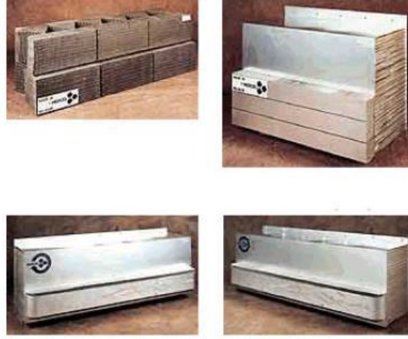
Şekil 2.4 Kompozit malzemeden üretilen çarpma test bariyerleri (Aydıncak, 2007)
