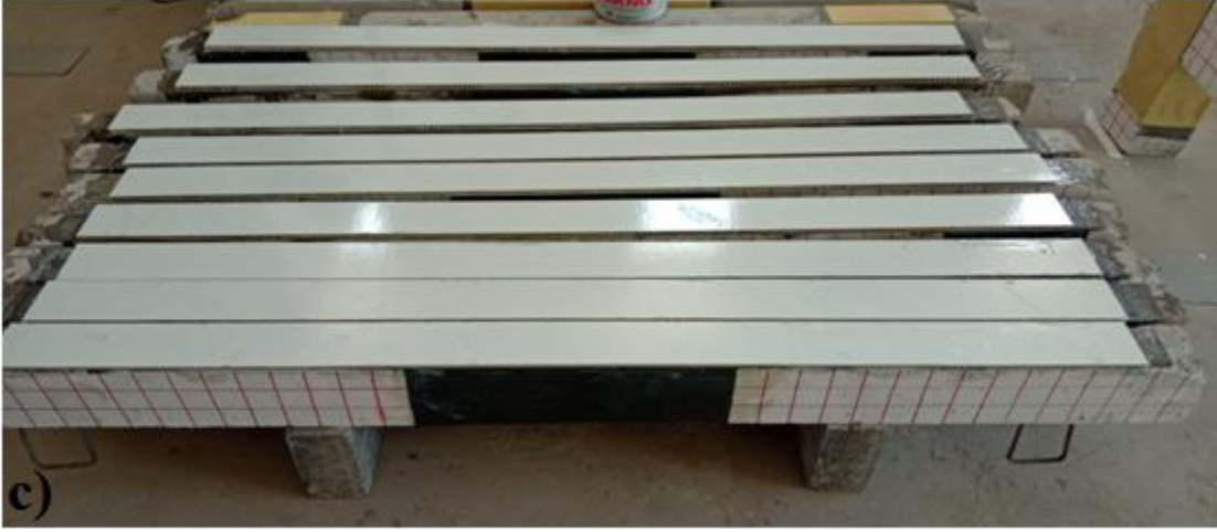
Şekil 3.7 Kirişlerin güçlendirme aşamaları
